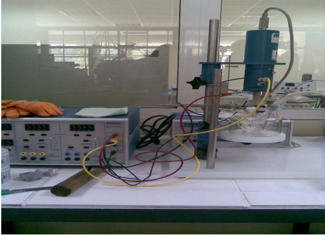
Resim 7.2. Döngülü voltametri (CV) ve CO sıyırma voltametrisi deney düzeneği
