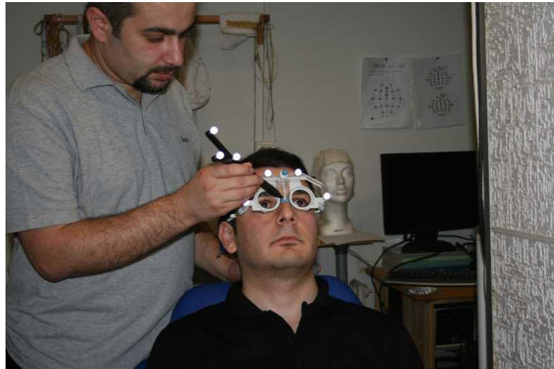
Şekil 3-6: Özel İzleçle Katılımcı Üzerinde Referans Nokta İşaretlenmesi
