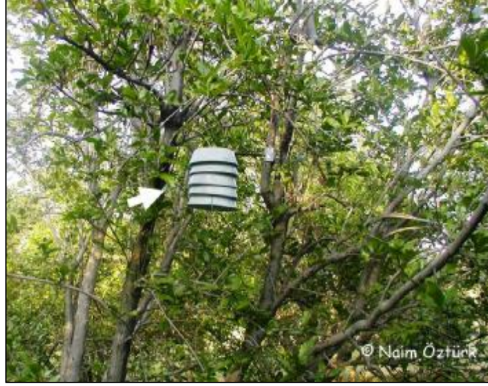
Resim 3.4. İklim verilerinin alınmasında kullanılan Hobo marka veri cihazı
