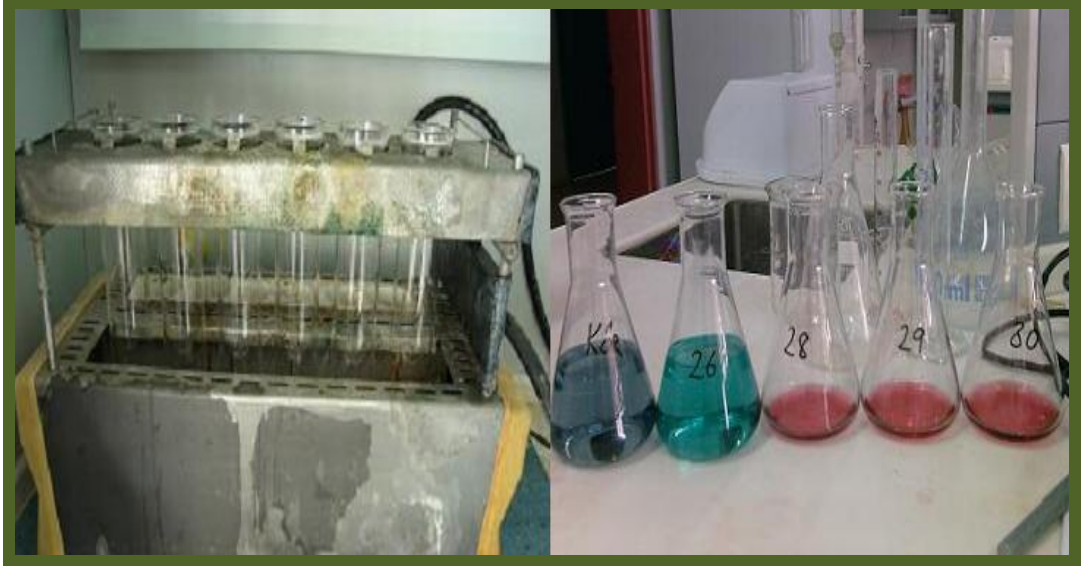
Şekil 3.9. Örneklerin yakma ünitesinde bekletilmesi ve titrasyonu.
