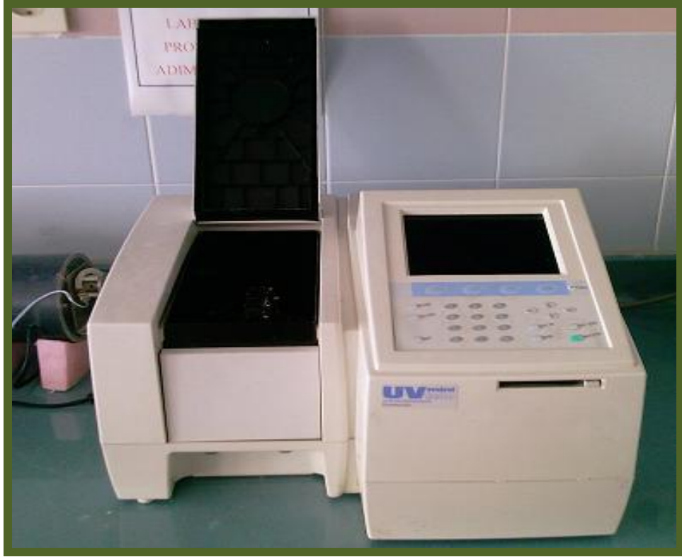
Şekil 3.8. Spirulina platensis kültürlerinin optik yoğunluk ve klorofil değerini ölçmede kullanılan spektrofotometre cihazı.
