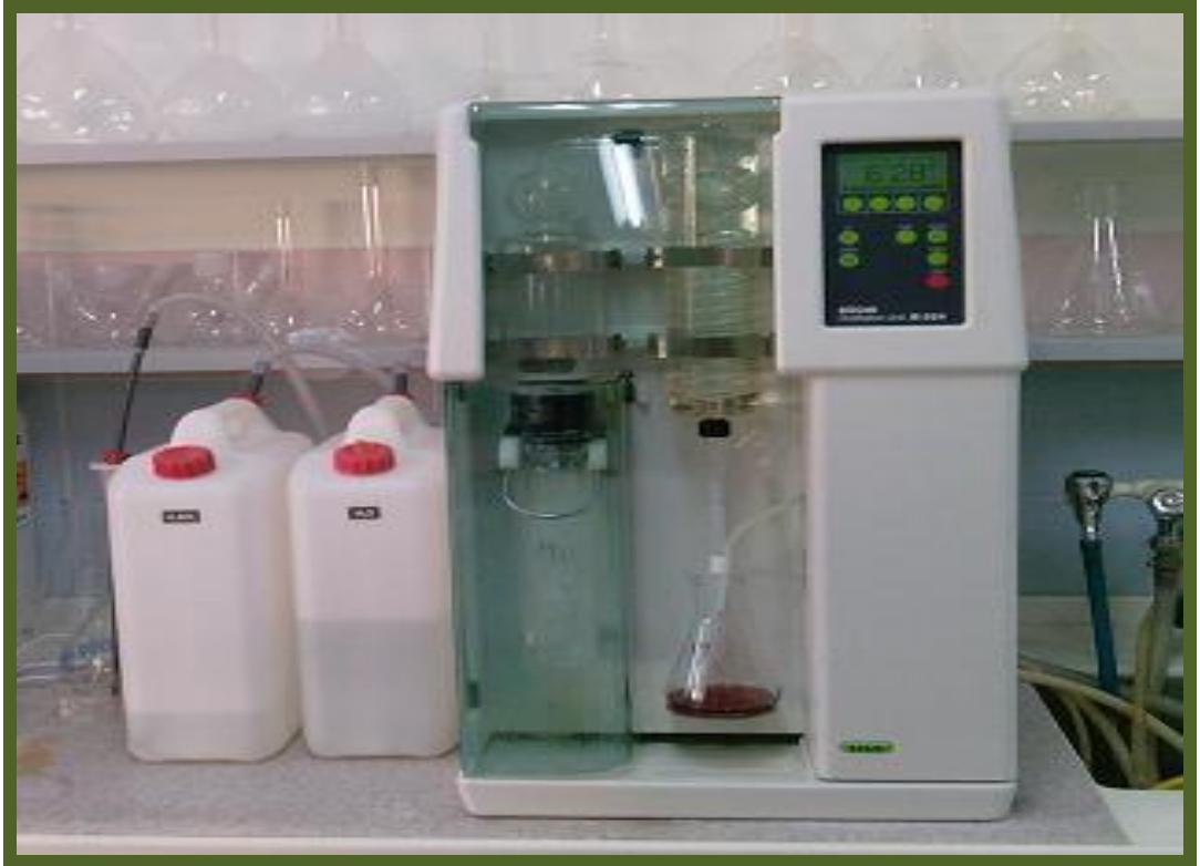
Şekil 3.10. Protein analizinde kullanılan Kjeltec cihazı.
