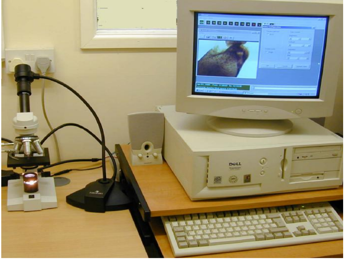
Şekil 3.2. Mikroskop altında incelenen malzemenin görüntüsünün kamerayla bilgisayara aktarılması.
