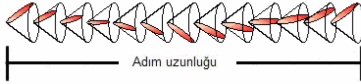
Şekil 1.10. Kolesterik sıvı kristal: helikal yapının şematik gösterimi.
