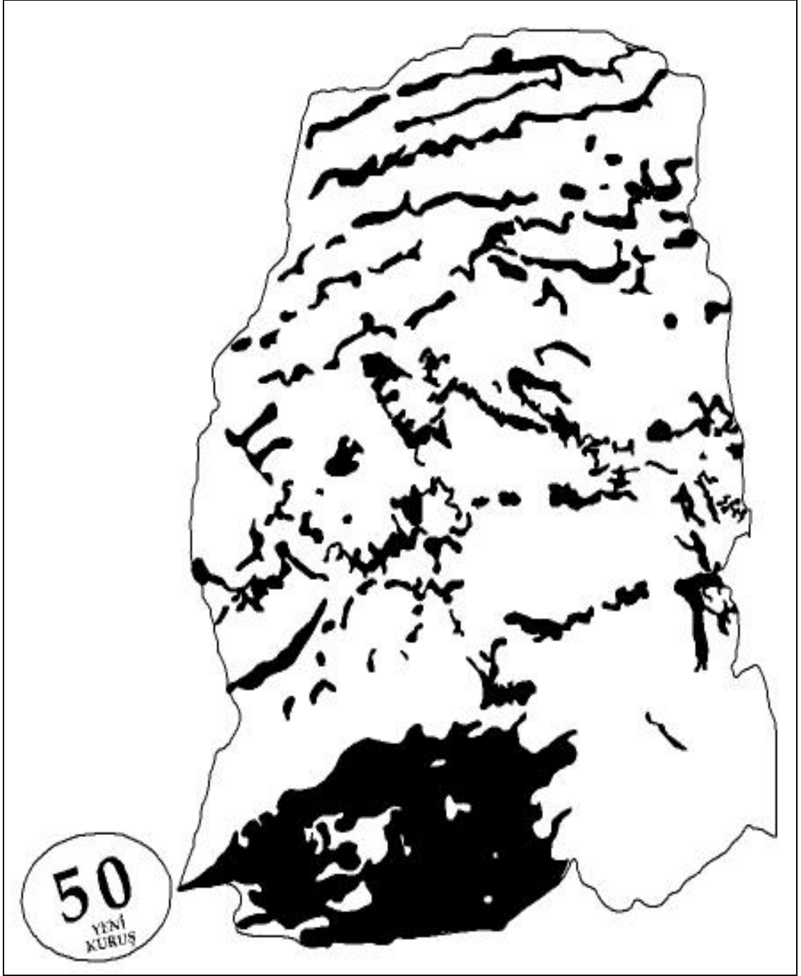
Şekil 7.4 Şekil 7.3’de verilen örneğe özgü, sideritler ile birlikte (eş yaşı) çökelen grafitlere (bitüm) ait az da olsa hissedilebilen kıvrım yapılarının fotoğraf üzerinden Freehand 8.0 çizim programı yardımıyla yapılan taraması (Şekil 7.3 ile aynı ölçek kullanılmıştır)
