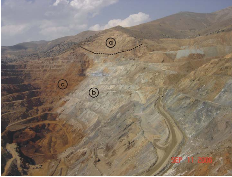
Şekil 3.8 Değirmentaş Formasyonuna ait Ankeritik Kireçtaşı Üyesi (a. Ankeritik Kireçtaşı Üyesi, b. Emirgazi Formasyonu ve c. Attepe demir yatağının KB sektörüne özgü cevher)
