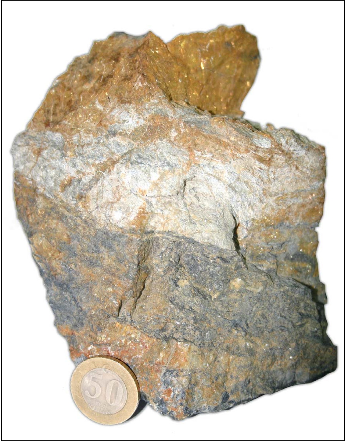
Şekil 7.5 Sideritler ile bitümlü (grafit) seviyeler arasındaki sedimantasyonla eş yaşı (sinsedimanter) ilişki
