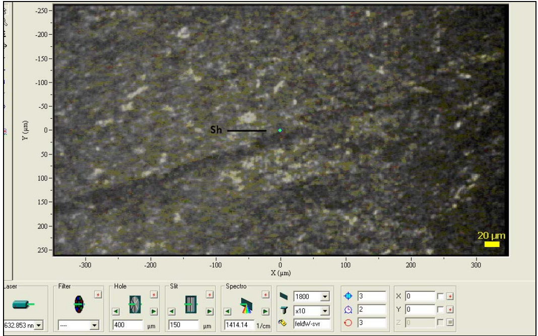
Şekil 4.30 A1-S4 nolu siderit örneğinde saptanan, farklı bir şörtit (Sh) mineraline ait görüntü
