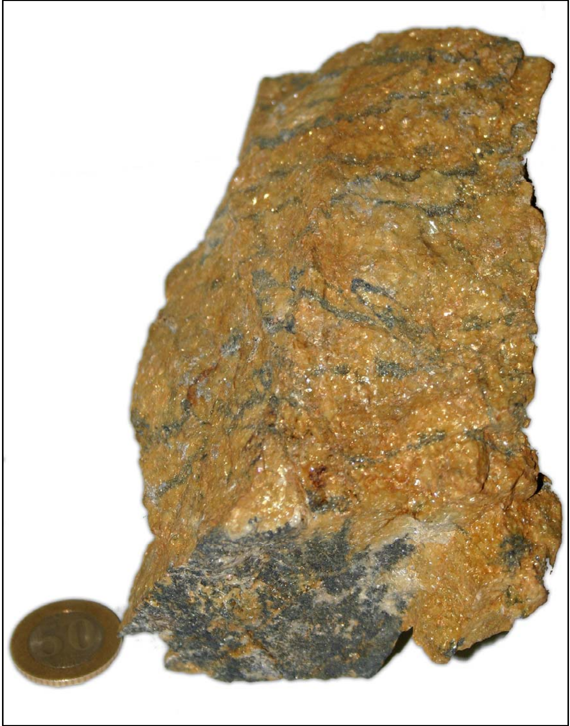
Şekil 7.3. Sideritler ile bitümlü (grafit) seviyeler arasındaki sedimantasyonla eş yaşı (sinsedimanter) ilişki (cevherleşme sonrası oluşan metamorfizmayla gelişen deformasyonlarla ilişkili grafitlerde (bitüm) az da olsa hissedilebilen kıvrım yapıları)
