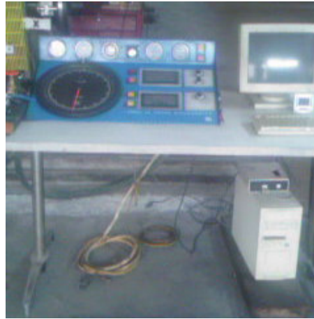
Şekil 3.3 Test ünitesi kontrol paneli.
