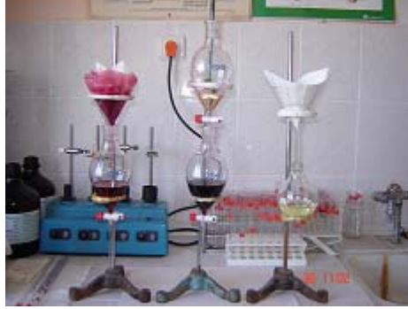
Şekil 3.7. Şeker pancarı (solda) ve greyfurt (sağda) numunelerinin ekstraksiyon aşamaları
