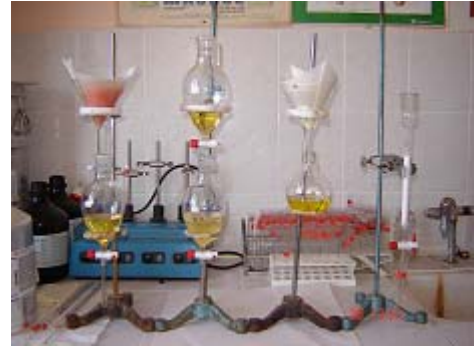
Şekil 3.7. Şeker pancarı (solda) ve greyfurt (sağda) numunelerinin ekstraksiyon aşamaları
