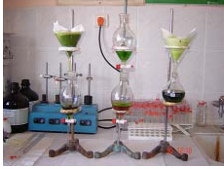
Şekil 3.6. Dereotu numunesinin ekstraksiyon aşamaları
