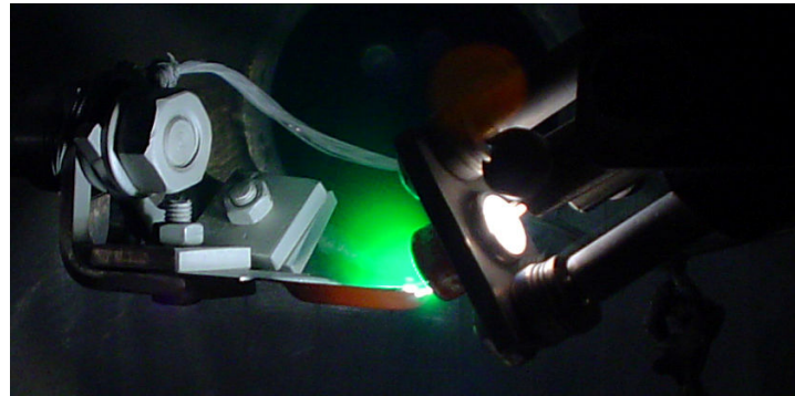
Şekil 5.68. 4 numaralı parametre grubu için Termiyonik Vakum Ark (T.V.A.) cihazında elde edilen gümüş metal plazmasının fotoğrafı
