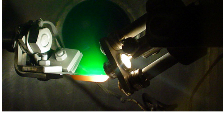
Şekil 5.66. 2 numaralı parametre grubu için Termiyonik Vakum Ark (T.V.A.) cihazında elde edilen gümüş metal plazmasının fotoğrafı
