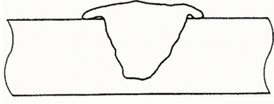
Şekil -21 Kaynak Dikişinde Taşma
