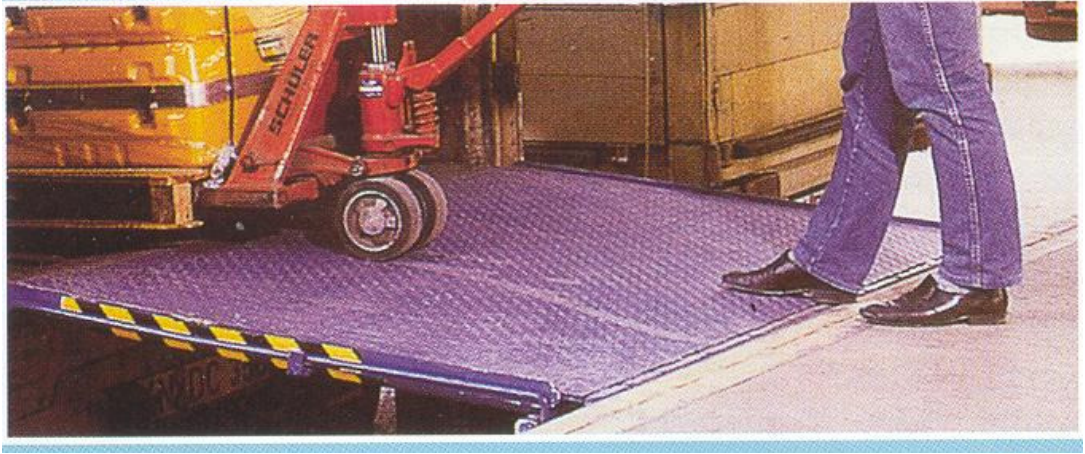
Şekil 5.3. Rampa Sistemi Örneği
