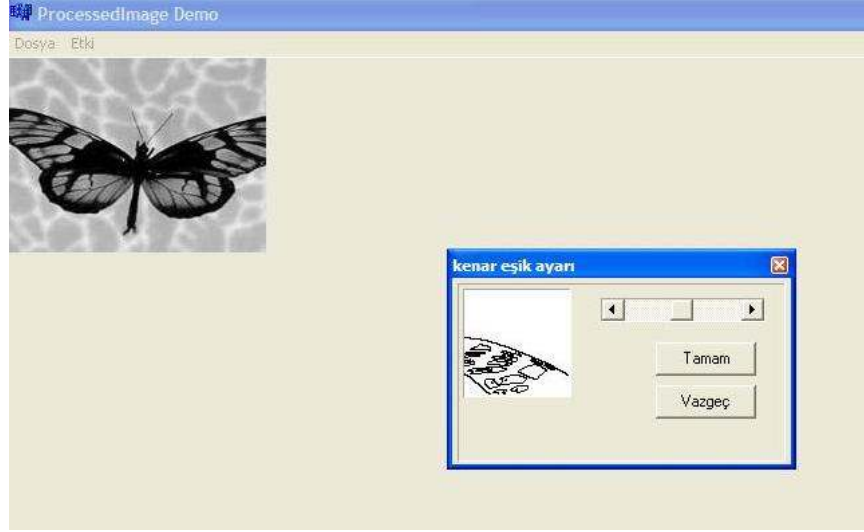
Şekil 4.6. Eşik değere göre kenar çıkarımı fonksiyonu
