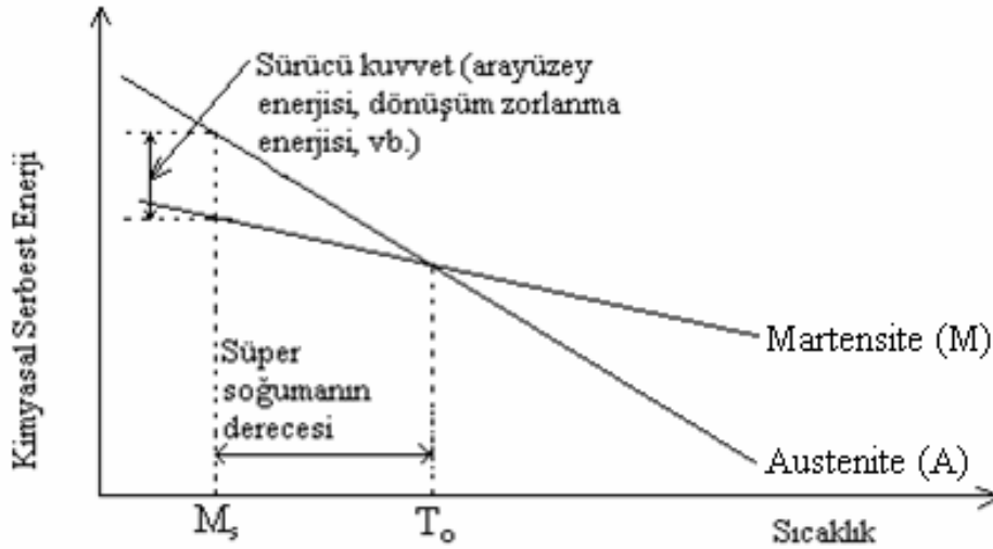
Şekil 2.6. Austenite ve martensite fazın kimyasal serbest enerjilerinin sıcaklık ve martensitik dönüşümle ilişkisi
