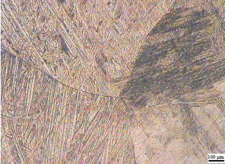
Resim 5.5. Alaşımın oda sıcaklığında x100 büyütmeyle çekilmiş yüzey resmi
