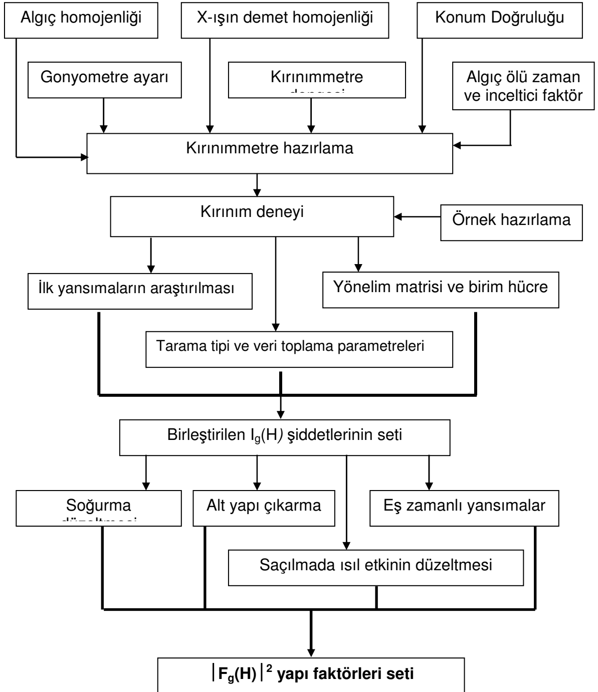
Şekil 3.7:X-ışını yapı analizinde |F_g(H)|^2 yapı faktörlerinin elde edilmesinde izlenen diyagram (Aslanov et al., 1998).
