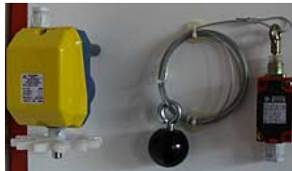
Şekil 6.8. Kablonun kıvrılmasını önleyici sistem [Özgür, 2002].
