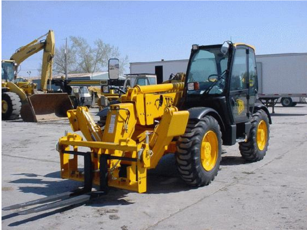
Fotoğraf 2.6. Teleskobik kollu lastik tekerlekli yükleyici [Contractorshotline, 2005]
