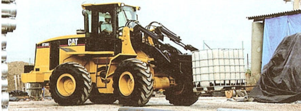
Fotoğraf 3.2. Paralel kol tasarımına sahip yükleyici [Equipment Magazine, 2005]
