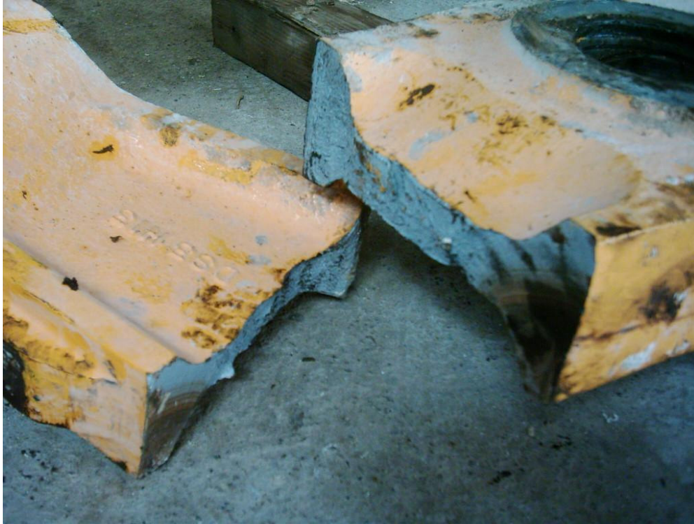
Fotoğraf 6.4. Kırılmış taşıyıcı kol
