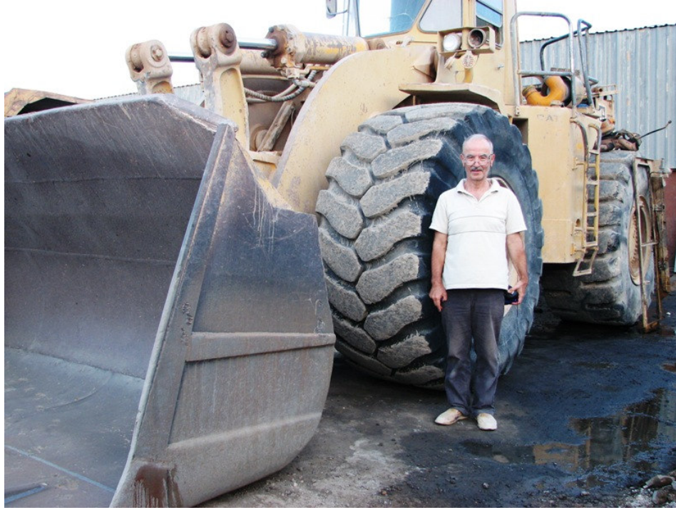
Fotoğraf 3.1. Z-Bar tasarımına sahip yükleyici [Çolpan, 2006]
