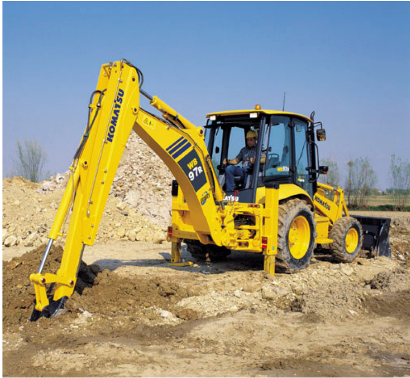
Fotoğraf 2.5. Tipik bir kazıcı yükleyici sabitleme durumunda [Komatsu, 2006]
