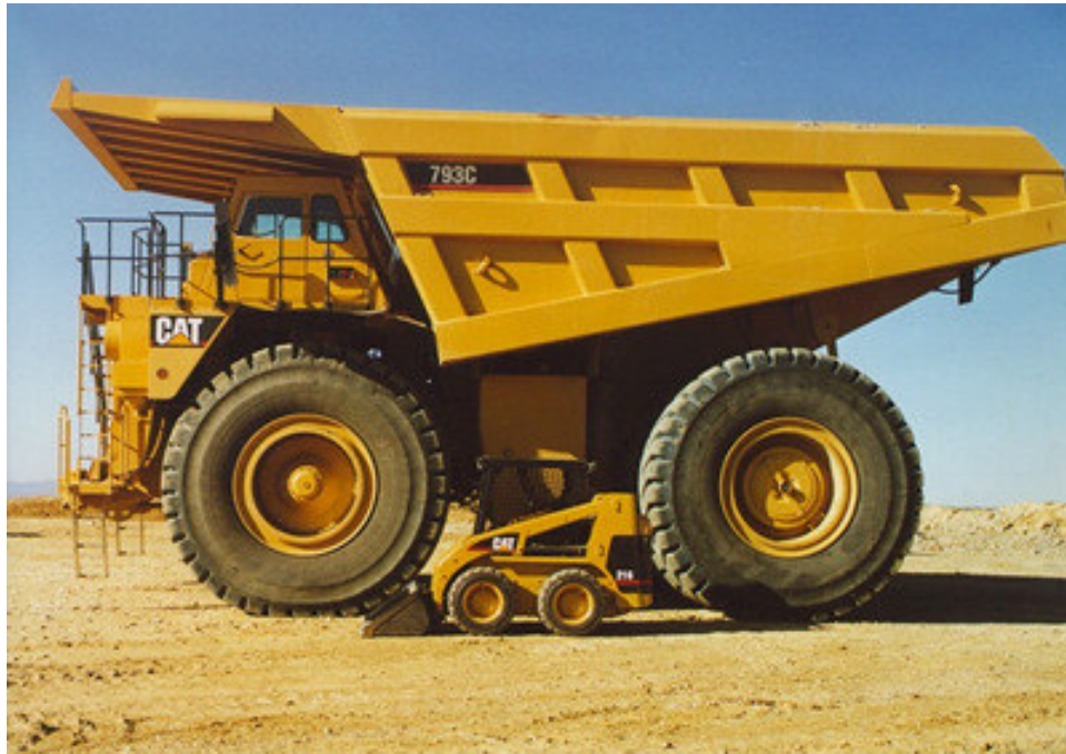
Fotoğraf 2.7. Mini yükleyicinin boyutları [Caterpillar, 2006]
