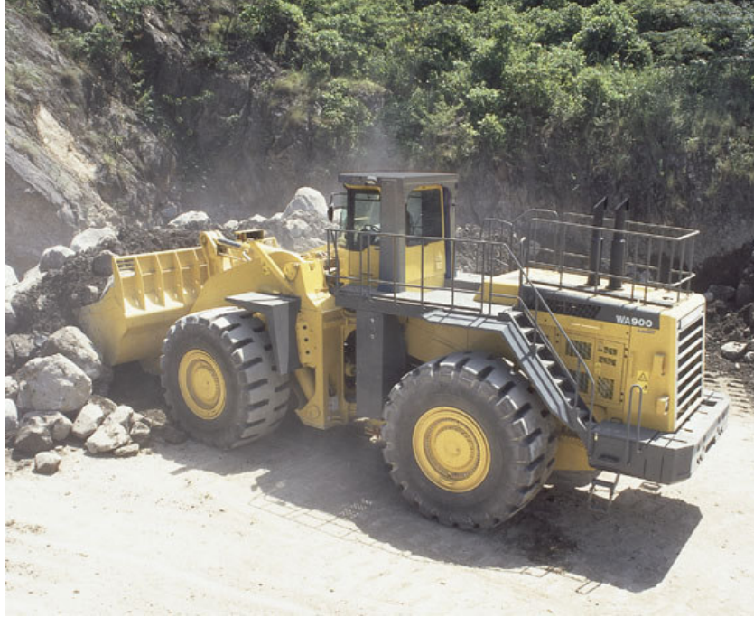
Fotoğraf 2.4. Tipik bir yüksek tonajlı lastik tekerlekli yükleyici [Komatsu, 2006]
