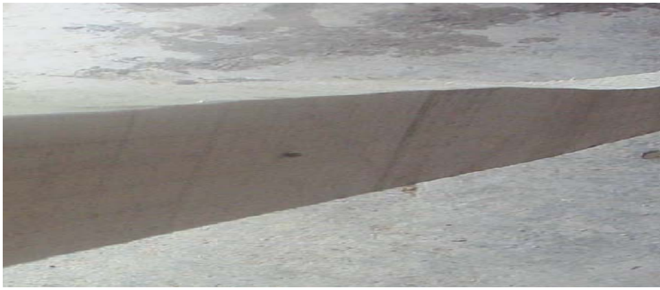
Şekil 1.23 Burulmuş şekilde biçilmiş kerestenin görünüşü (Foto:Dönmez, 2005).
