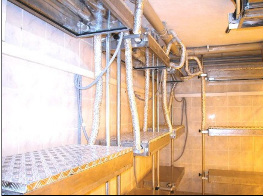
Şekil 3.1 Denemelerin yürütüldüğü iklim odası
