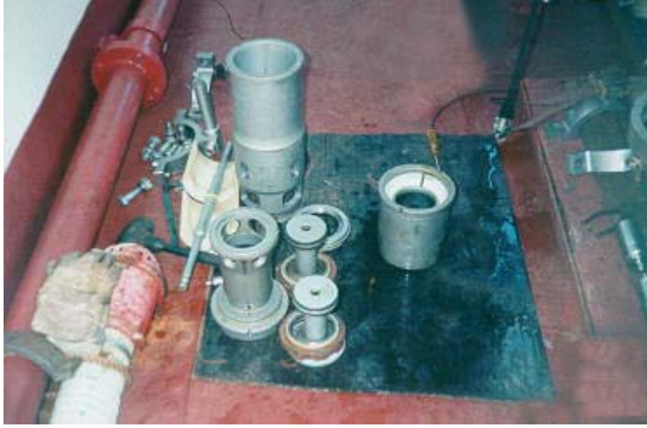
Şekil 8.4. Demonte halde ki GI Gun.
