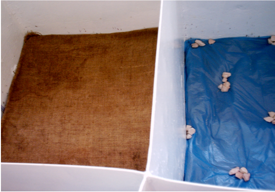
Şekil 5.16. Geçirimsizlik tabakasının üzerine nemli çuval ve naylon örtülmesi
