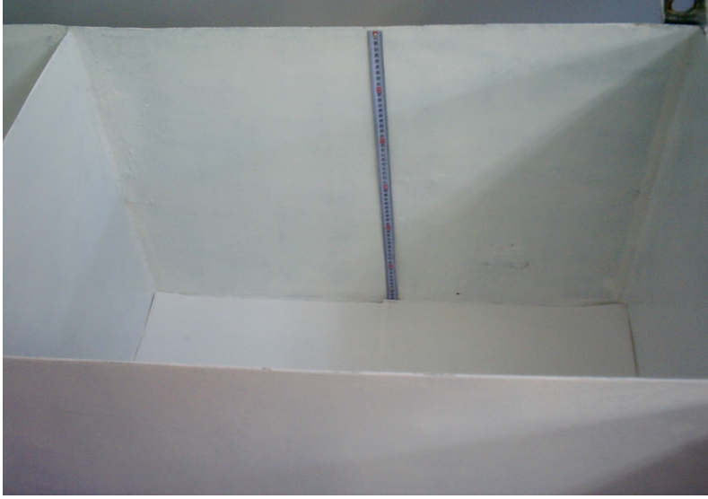
Şekil 5.11. İki kat poroz kağıt yerleştirilen deponi bölmeleri
