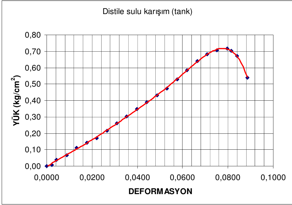
Şekil 6.17. Distile sulu karışımın (tank)16 haftalık kür serbest basınç grafiği (2) (W= 746 gr H= 11,3 cm D= 7,4 cm q_u= 0,72 \text{ kg/cm}^2= 71 \text{ kPa} )
