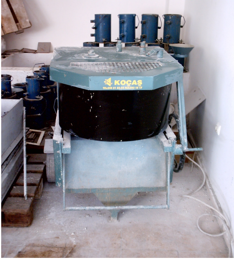
Şekil 5.8. Geçirimsizlik malzemelerinin karıştırıldığı mikser
