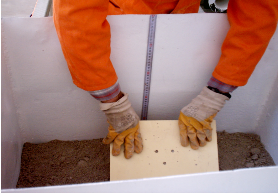
Şekil 5.13. Geçirimsizlik malzemesinin sıkıştırılmadan önce bölme içerisinde yayılması
