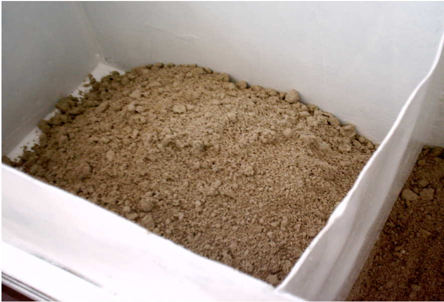
Şekil 5.12. Geçirimsizlik malzemesinin sıkıştırılmamış hali
