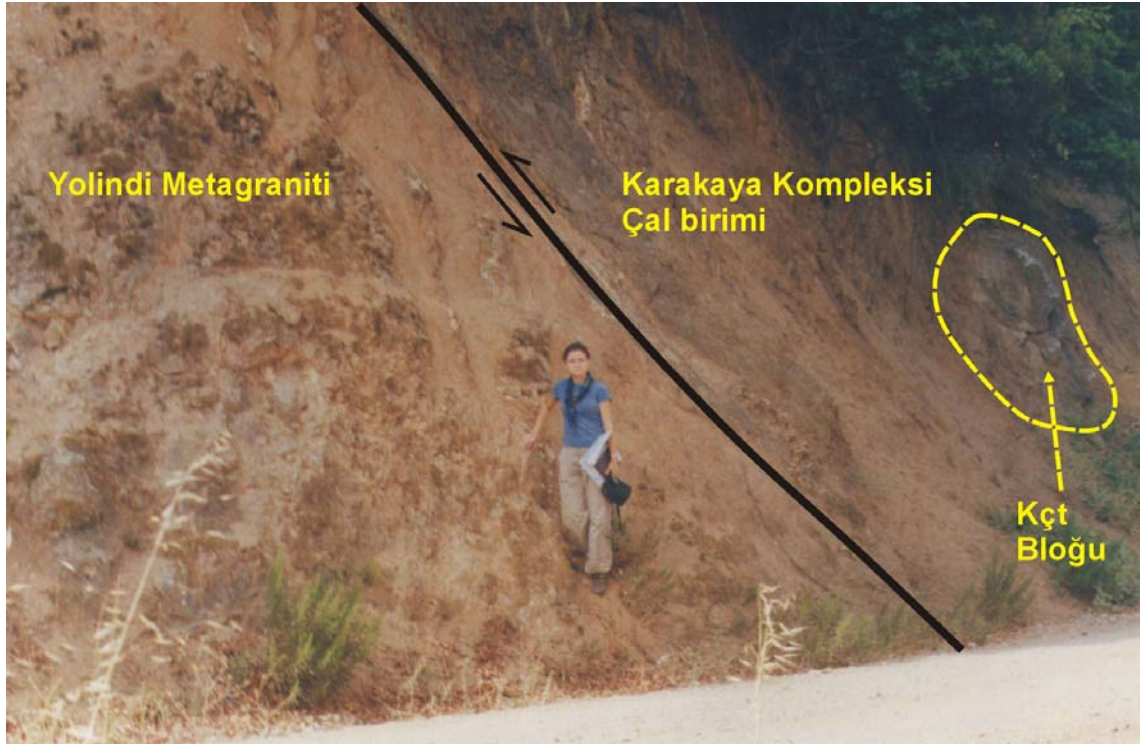
Şekil 4-102. Yolindi metagraniti ile Karakaya kompleksi arasındaki fay düzlemi. Taşoluk barajı ile Taşoluk obası arasındaki yol yarması. Fay düzlemi K25B doğrultulu ve 50° GB'ya eğimlidir.
