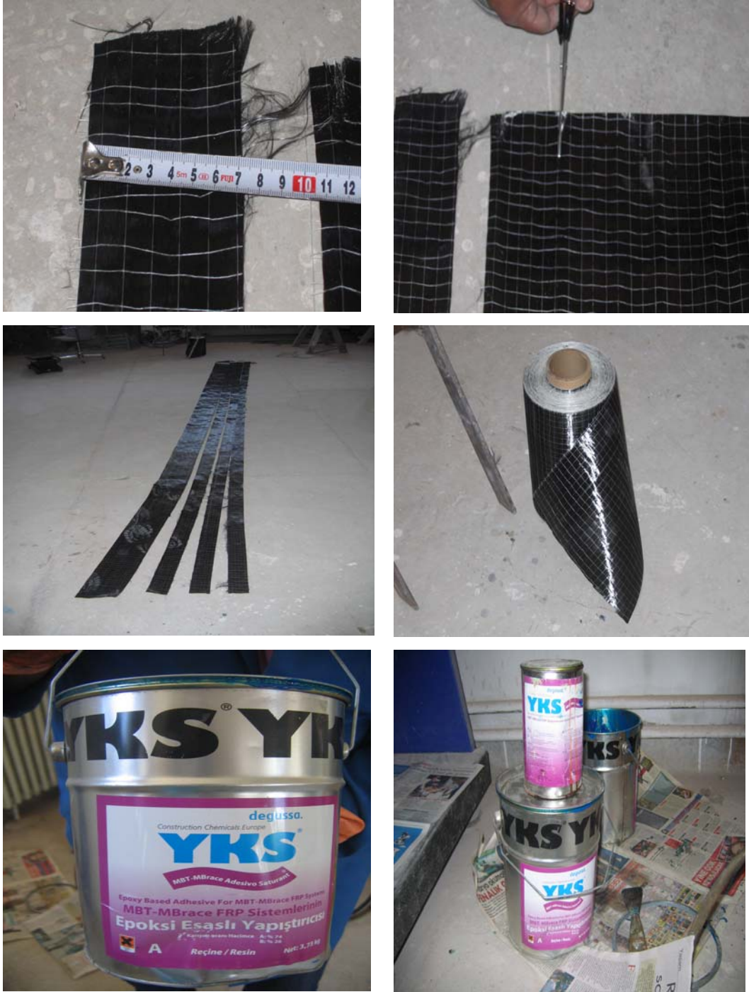
Şekil 3.6 Deneyde kullanılan karbon fiber ve kullanılan reçine
