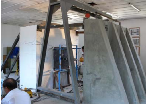
e) Mesnet levhasının sağ yanında çatlak
