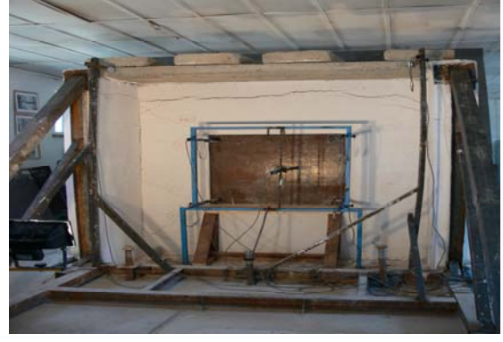
d) Arka duvarın orta kısmındaki çatlaklar
