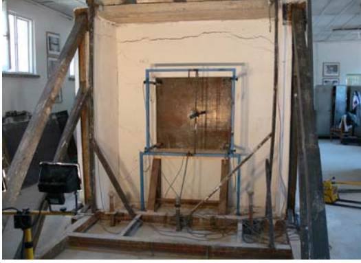
c) Arka duvarda oluşan çatlaklar
