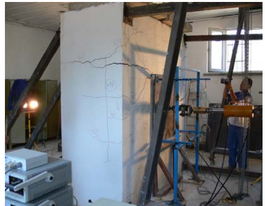
b) Ön duvarla sol yan duvarın birleşim bölgesindeki çatlaklar
