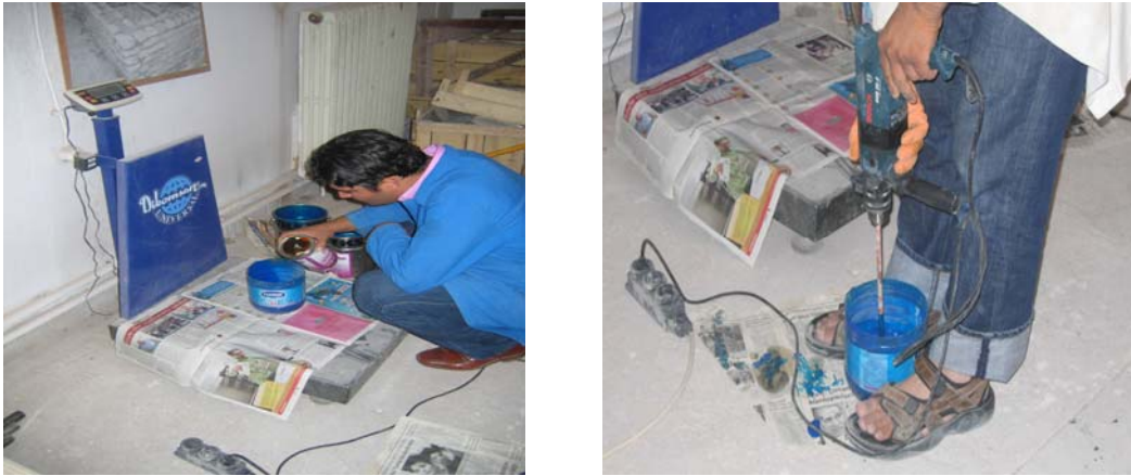
Şekil 3.10 Deney numunesine sürülecek reçinenin hazırlanması
