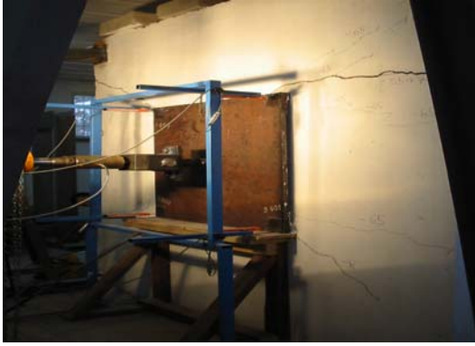
c) Yükleme levhasının sol üst ve alt bölgesinde oluşan çatlaklar
