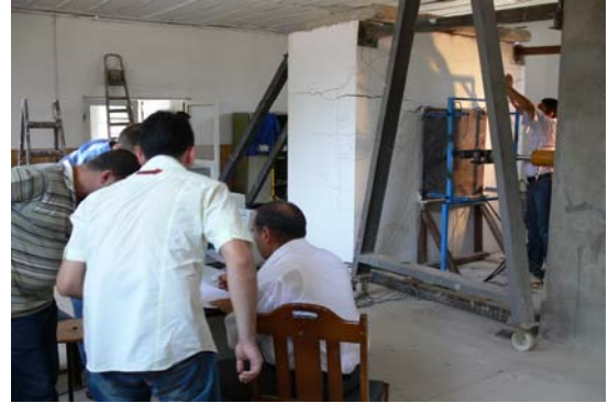
f) Sol yan duvarda oluşan çatlaklar
