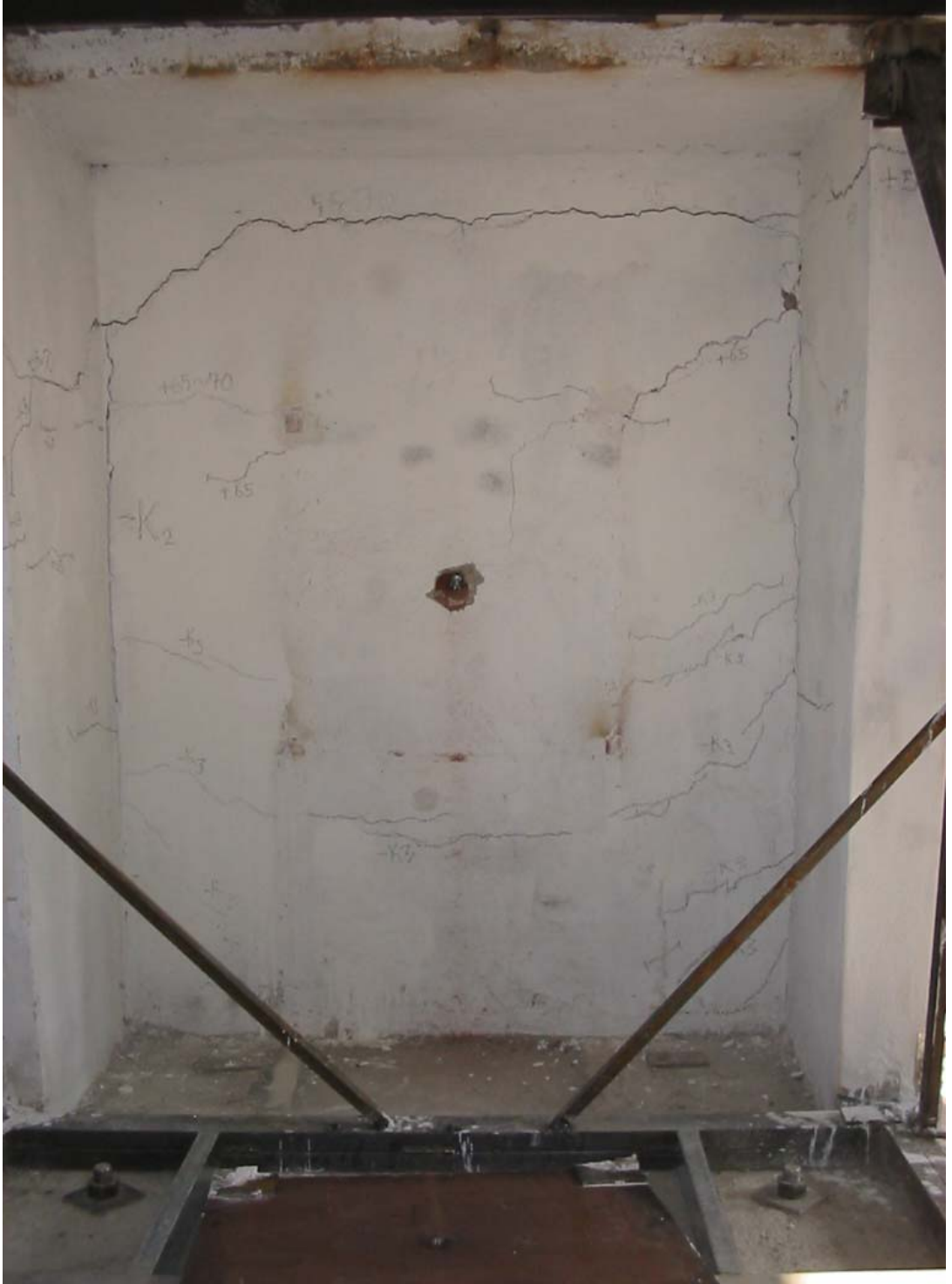
Şekil 5.13 1 nolu deney numunesinin deney sonundaki genel görünüşü
