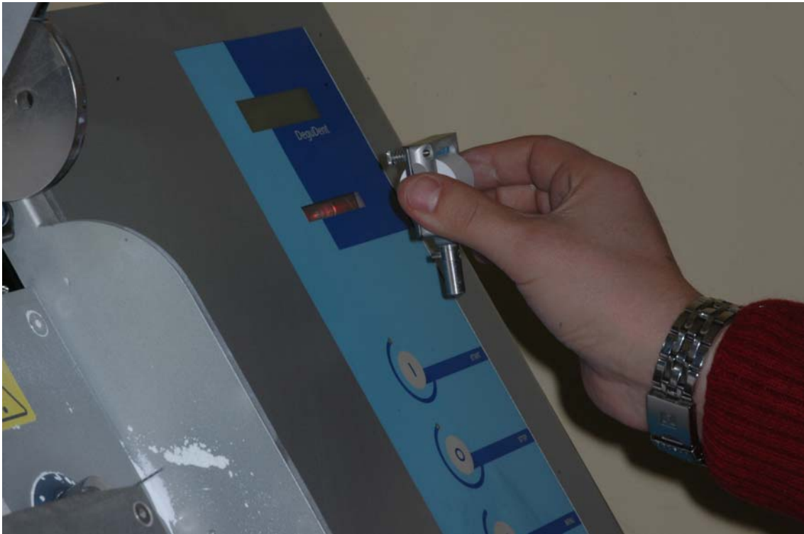
Şekil 40- Uygun Cercon bloğun Cercon Brain cihazına okutulması.
