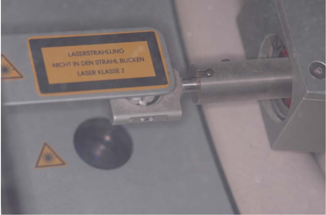
Şekil 41- Hazırlanan örneklerin Cercon Brain cihazına okutulması.
