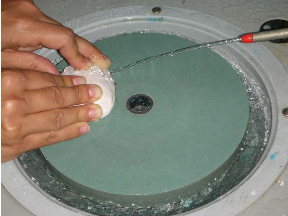
Şekil 49- Örnek yüzeylerinin DAP-U aletinde aşındırılması.
