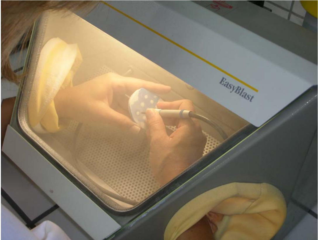
Şekil 55- 110 \mu\text{m} 'luk \text{Al}_2\text{O}_3 kumu ile kumlama.
