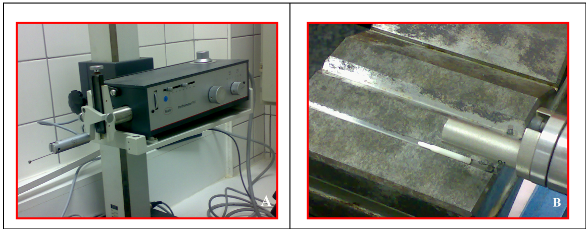
Şekil 3.6.1: Yüzey pürüzlülüğü ölçümü A) Perthometer cihazı; B) Post yüzeyinin incelenmesi
