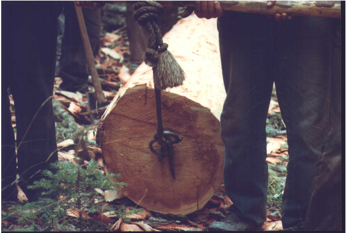
Şekil 3.3 Tomrukların insan gücü ile zeminde sürütülerek taşınması (Fotoğraf: K. Menemencioğlu, 2004).
