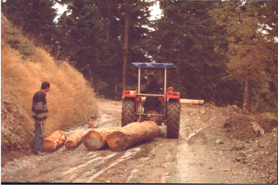
Şekil 3.5 Tarım traktörü (Massey Ferguson 240 S) ile orman yolunda zeminde sürütme (Fotoğraf: K. Menemencioğlu, 2004).
