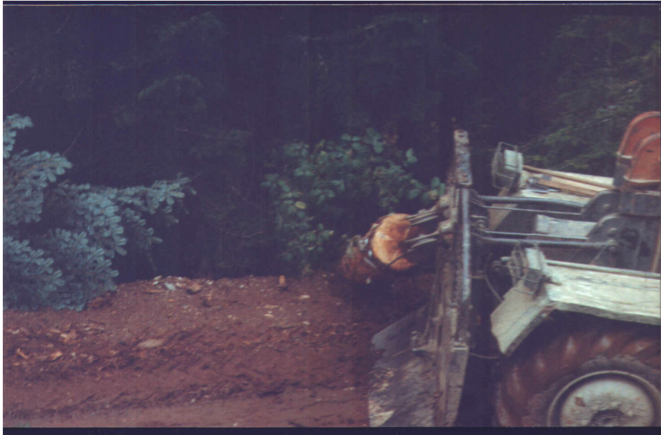
Şekil 3.6 Çift tamburlu orman traktörü (MB Trac Turbo 900) ile bölmeden çıkarma (Fotoğraf: K. Menemencioğlu, 2004).
