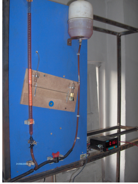
Şekil 6.5 Yakıt tüketimi ölçüm düzeneği.
