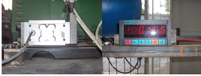
Şekil 6.6 Load cell'in ve indikatörün görünümü.
