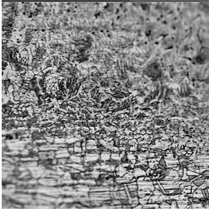
Şekil 5.62 4.EA.1 no.lu numuneye ait kaynak dikişi ve ITAB (400X)
