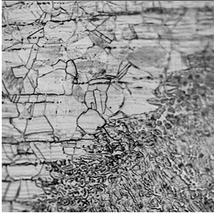
Şekil 5.41 2.EA.1 no.lu numuneye ait kaynak dikişi ve ITAB (400X)
