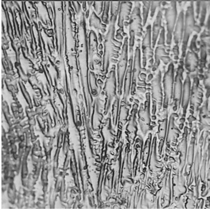
Şekil 5.40 2.EA.1 no.lu numuneye ait kaynak bölgesi (400X)
