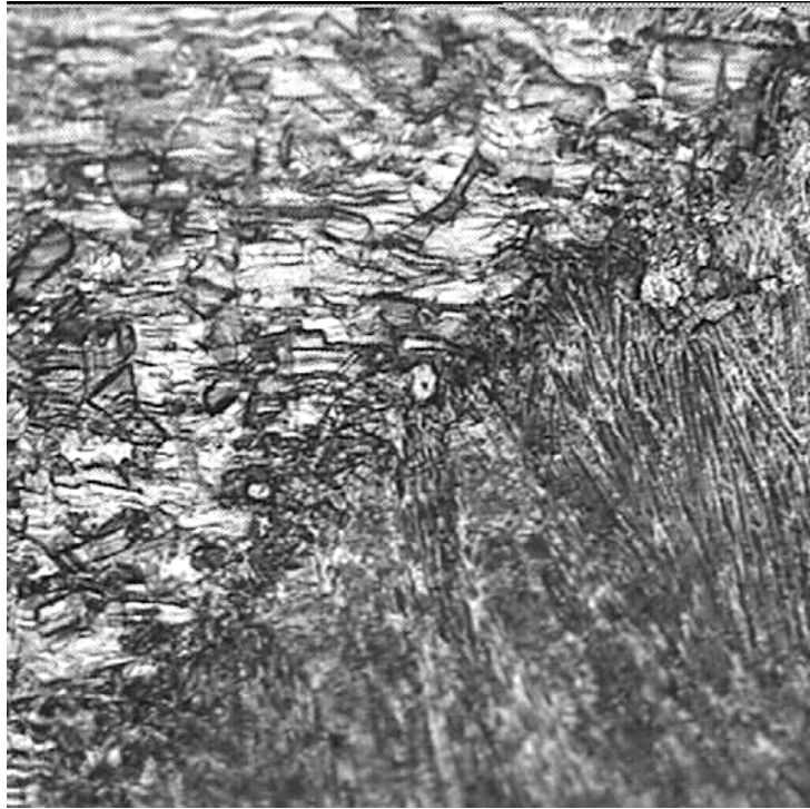
Şekil 5.38 1.TIG.1 no.lu numuneye ait kaynak dikişi ve ITAB (400X)
