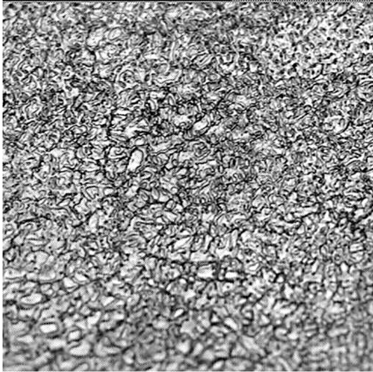
Şekil 5.56 3.TIG.1 no.lu numunenin kaynak bölgesi (400X)
