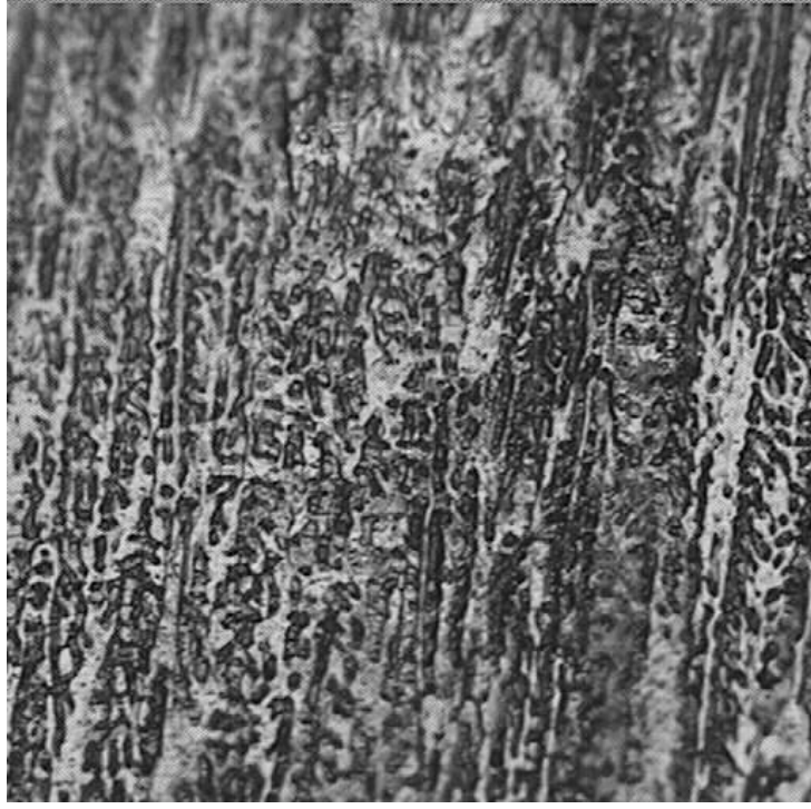
Şekil 5.37 1.TIG.1 no.lu numunenin kaynak bölgesi (400X)
