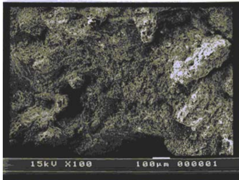
Şekil 5.77 316Ti’nin elektrik ark kaynağında E 318L-16 elektrot-yüksek akım koşulunda oluşan gevrek kaynak dikişinin kırık yüzey fotoğrafı
