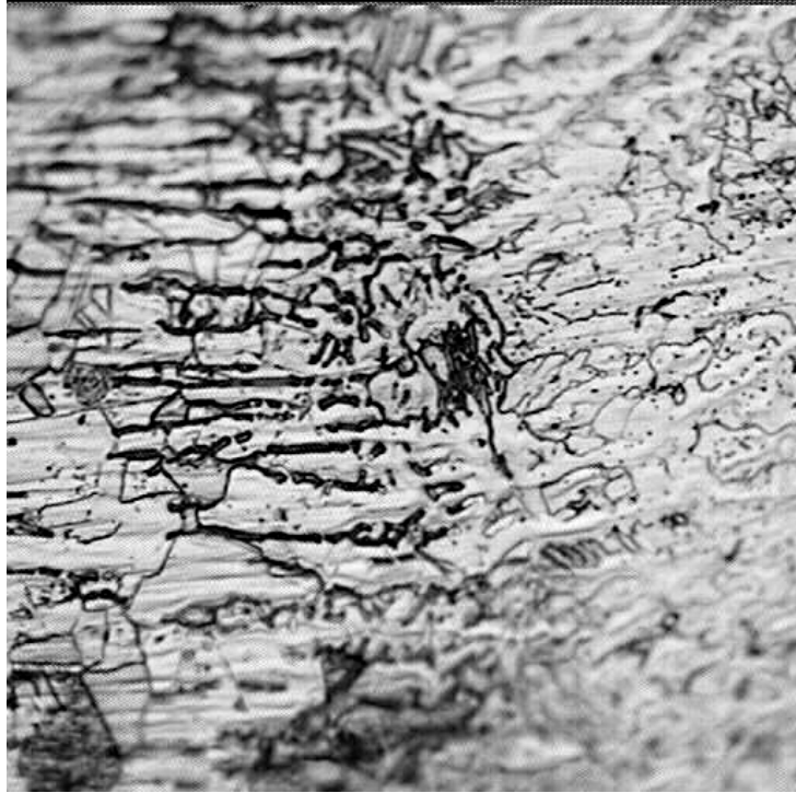
Şekil 5.36 1.EA.3 no.lu numuneye ait kaynak dikişi ve ITAB (400X)
