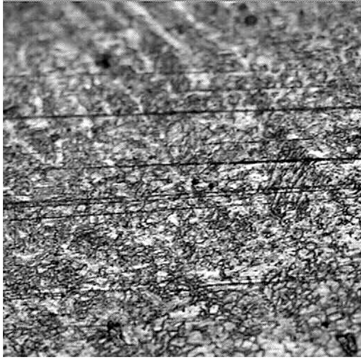
Şekil 5.61 4.EA.1 no.lu numunenin kaynak bölgesi (400X)
