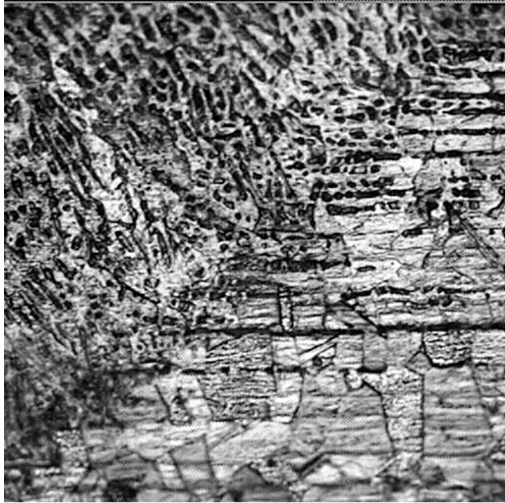
Şekil 5.52 3.EA.1 no.lu numuneye ait kaynak dikişi ve ITAB (400X)
