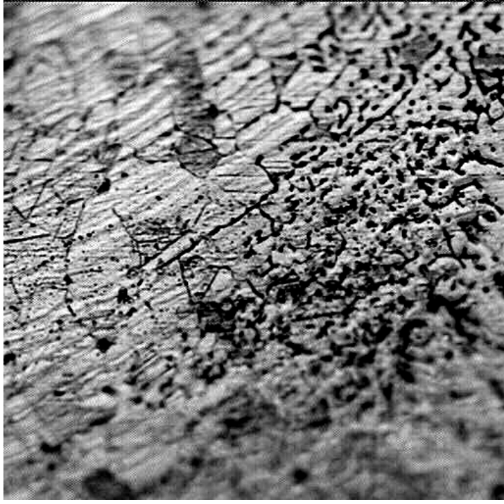
Şekil 5.55 3.EA.3 no.lu numuneye ait kaynak metali ve ITAB (400X)
