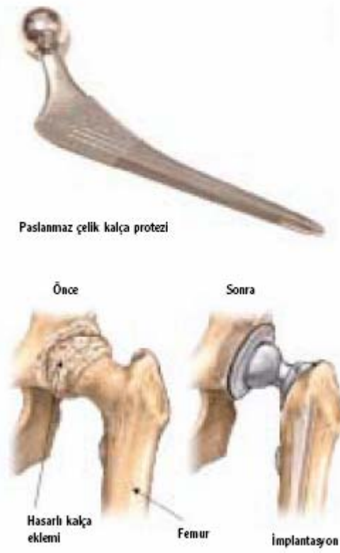
Şekil 3.26 316L tipi paslanmaz çelik kalça protezi ve uygulaması (tubitak.gov.tr)
