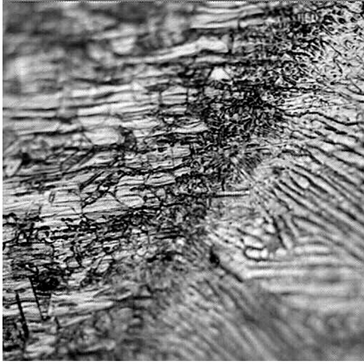
Şekil 5.39 1.TIG.2 no.lu numuneye ait kaynak dikişi ve ITAB (400X)
