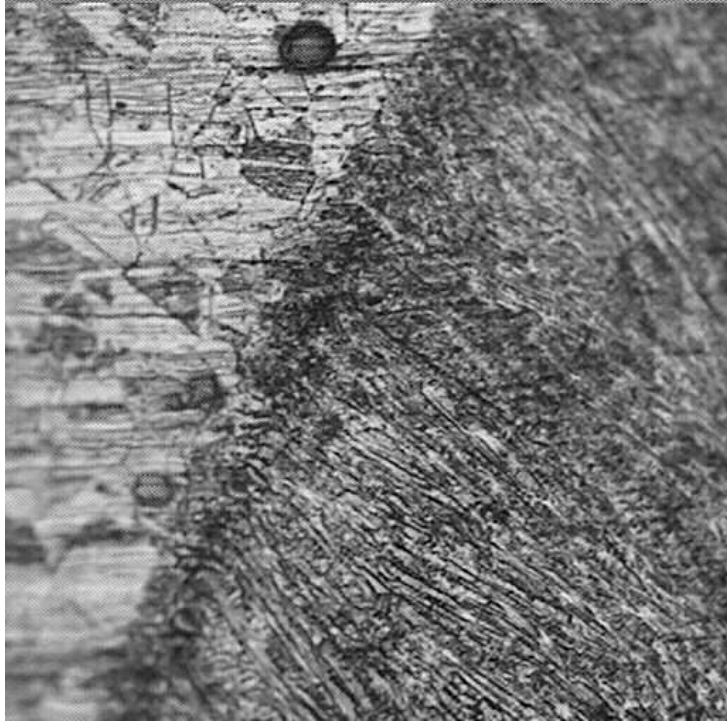
Şekil 5.59 3.TIG.2 no.lu numuneye ait kaynak dikişi ve ITAB (400X)
