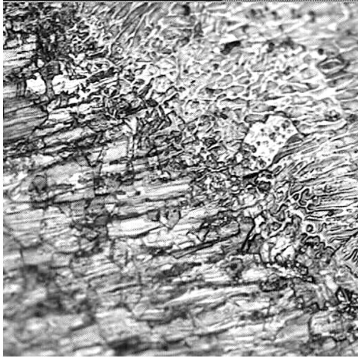
Şekil 5.32 1.EA.1 no.lu numunenin kaynak dikişi ve ITAB (400X)
