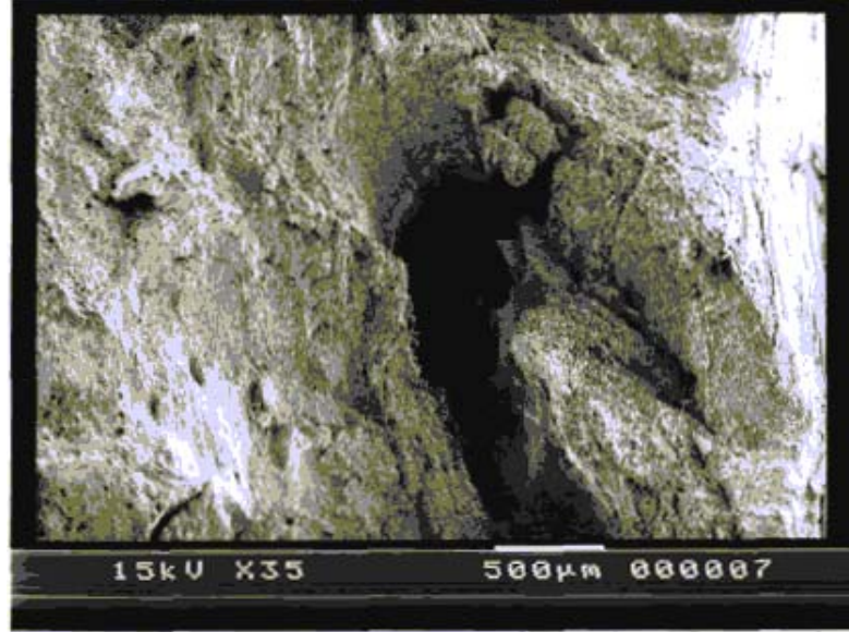
Şekil 5.76 304 malzemenin TIG kaynağında yanlış akım koşulunda oluşan kaynak dikişinin kırık yüzey fotoğrafı
