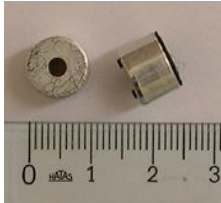
Şekil-72. CZN 15E elektret kondansatör mikrofon.
