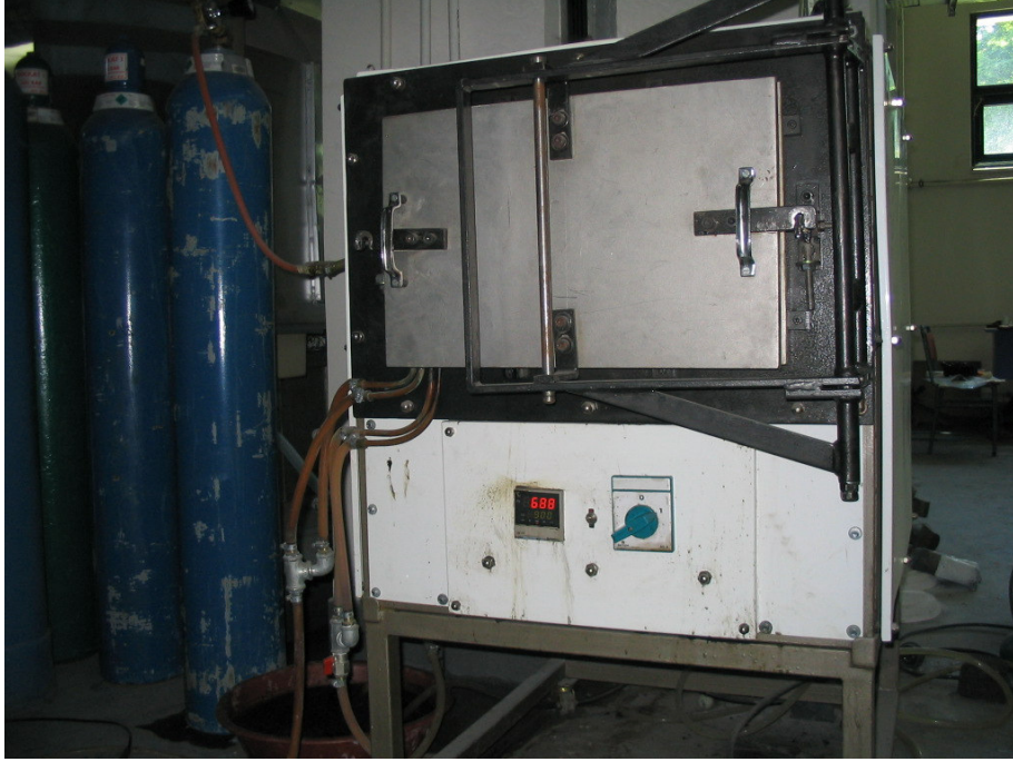
Şekil 5.2 Argon gazı kontrollü atmosferli elektrikli östenitleme fırını
