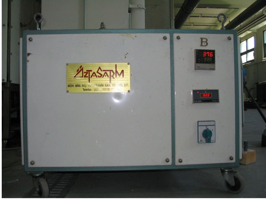
Şekil 5.3 Numunelerin östemperlenmesini sağlayan tuz banyosu
