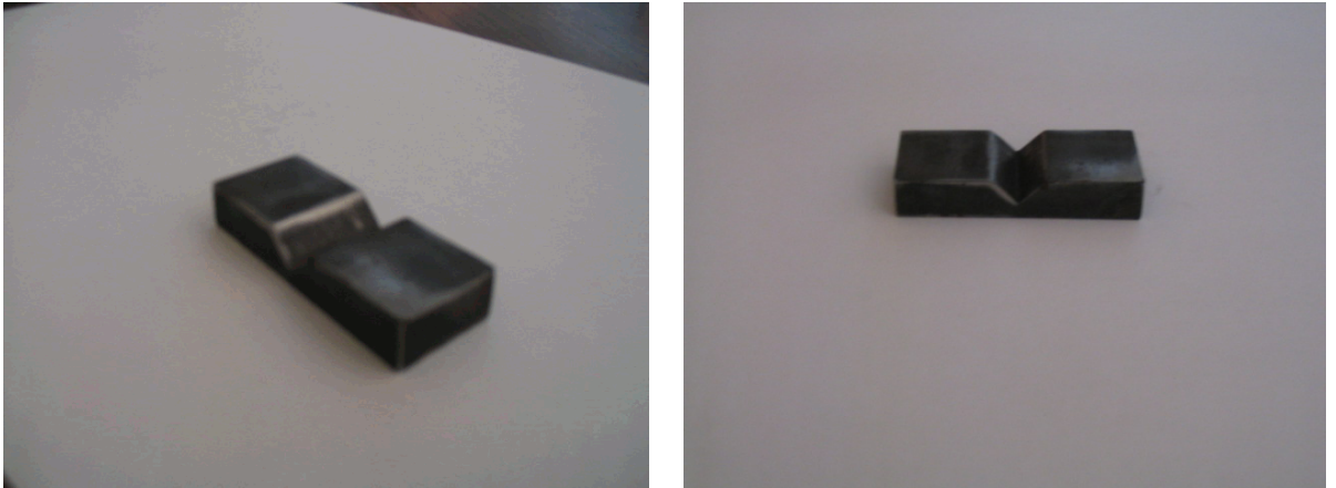
Şekil 5.1 60x20x10 boyutunda V kaynak ağzı açılmış küresel grafitli dökme demir numunesi
