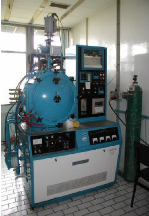
Şekil III.8 Sinterleme fırınının genel görünüşü. Şekil III.9. Küçük tip sinterleme fırınının genel görünüşü
