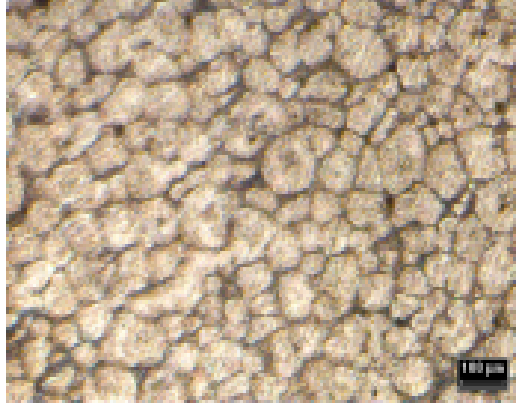
Şekil IV.31. 1250°C’de 30 dakika. sinterlenmiş ,% 0,8 NiB ilaveli 1000-C tipi numuneler için mikroyapı fotoğrafı.
