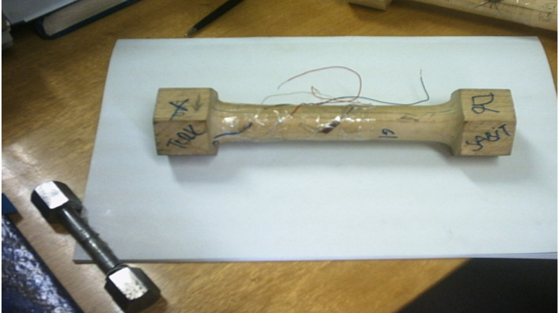
Resim 5.7. Numunenin ortasına ve tork uygulanan uç kısmına yerleştirilen iki geyçli büyük çam numunesi
