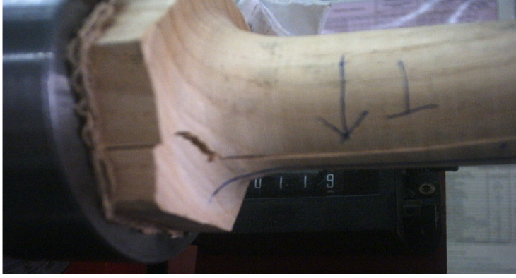
Resim 5.5. Yükleme sonucu lifleri ayrılan büyük içi boş çam numuneleri
