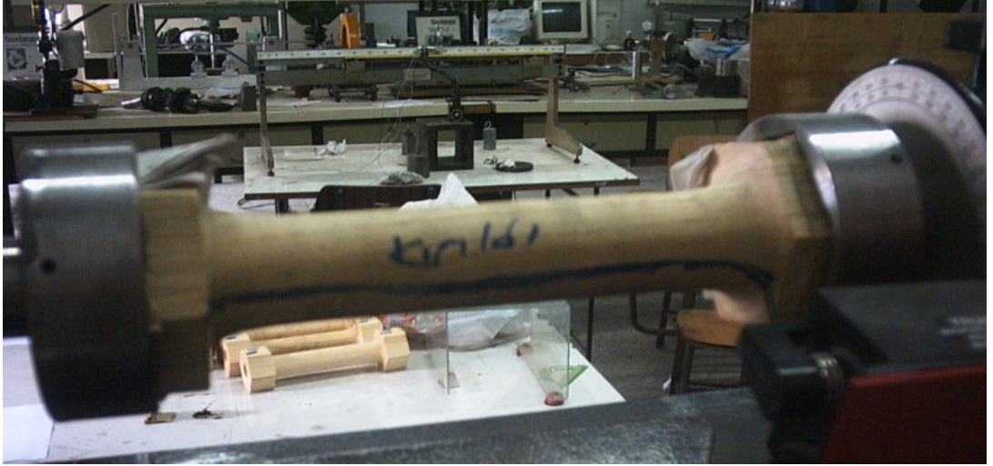
Resim 5.3. Yükleme sonucu lifleri ayrılan büyük içi boş çam numunesi
