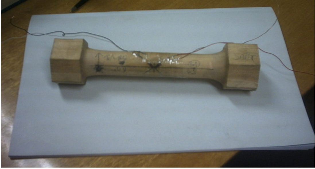
Resim 5.6. Numunenin ortasına birbirine dik açıyla yerleştirilmiş iki geyçli büyük çam numunesi
