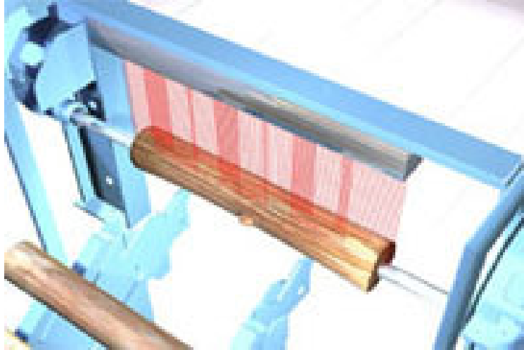
ekil 3.10 : Tomrukların XY ıını ile merkeziletirilmesi (www.raute.fi).
