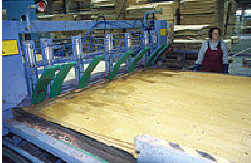
řekil 3.17 : Presleme öncesi hazırlanmıř LVL taslađı (www.raute.fi).
