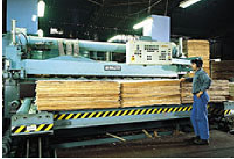
Şekil 3.12 : Kaplamaların kurutma bandına verilmesi (www.raute.fi).
