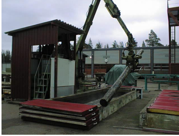
Şekil 2.15 : Pişirme işlemine tabi tutulmuş tomrukların havuzdan çıkartılması (www.plytec.com).
