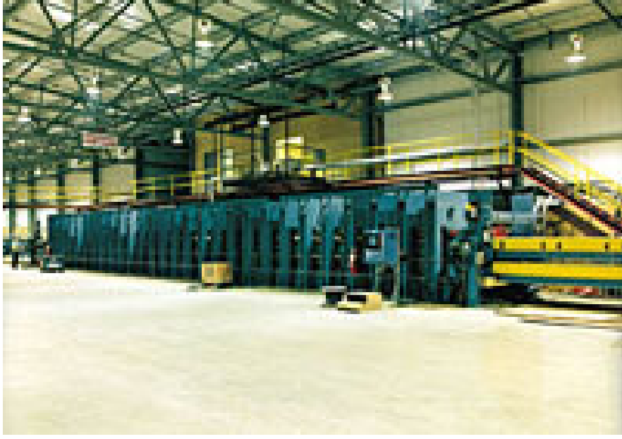
Şekil 3.13 : Kaplama kurutma hattı ( www.dieffenbacher.de ).
