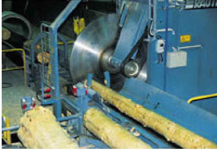
Şekil 3.4 : Tomruklarda baş kesme ve ebatlama işlemi (www.raute.fi).
