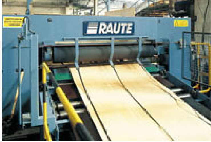
Şekil 3.11 : Tomrukların sonsuz bant halinde soyulması (www.raute.fi).
