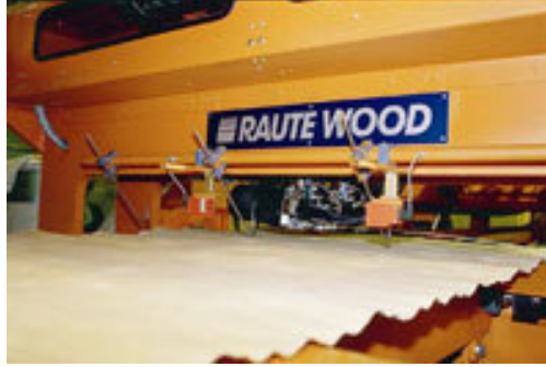
Şekil 3.14 : Kurutmadan çıkan kaplamaların rutubetinin ölçülmesi ( www.raute.fi ).
