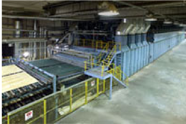
Şekil 2.18: Kaplama kurutma hattı (www.raute.fi).
