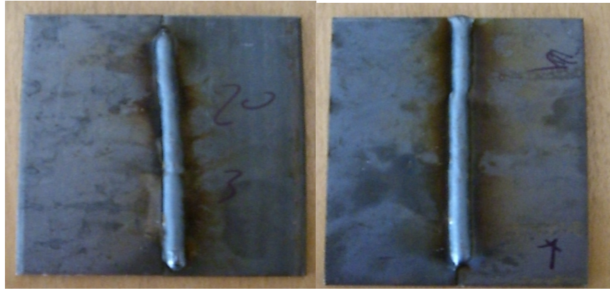
(a) Kaynak akımı 107 A, kaynak gerilimi 20 V, (b) Kaynak akımı 116 A, kaynak gerilimi 20 V,
