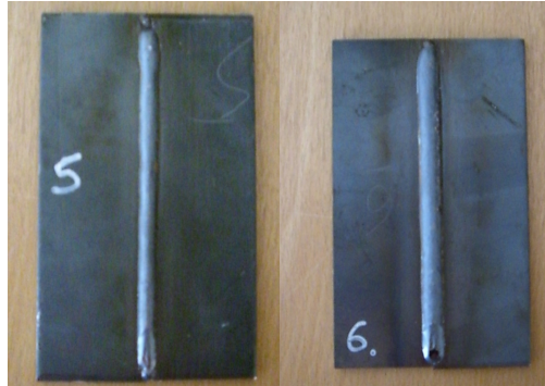
Şekil 4.10 Yeni nesil makinada darbeli kaynak yöntemiyle 145 amperde tüm kaynak parametreleri sabit, kaynak hızının değiştirilmesi sonucunda oluşan kaynak dikiş görüntüsü.
