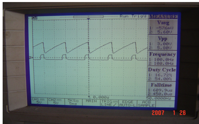
Şekil 3.9 Tel sürme hızının potansiyometresi 7.kademede olduğunda, tristör tetikleme sinyalinin osiloskoptaki görüntüsü.
