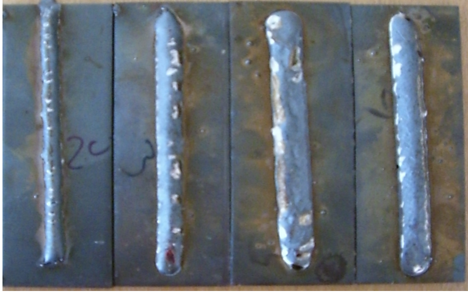
Şekil 4.6 Yeni nesil elektronik kaynak makinalarında akım sabit iken kaynak gerilimi 20, 24, 28, 32 volt olduğundaki kaynak görüntüleri (% 100 CO 2 gazı).
