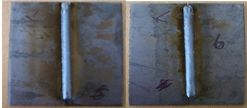
(c) Kaynak akımı 126 A, kaynak gerilimi 20 V (d) Kaynak akımı 138 A, kaynak gerilimi 20 V
