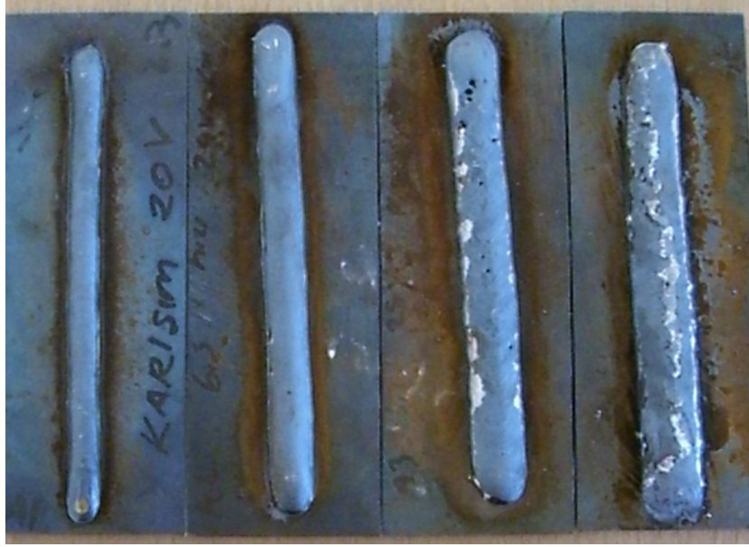
Şekil 4.5 Yeni nesil elektronik kaynak makinalarında akım sabit iken kaynak gerilimi 20, 24, 28, 32 volt olduğundaki kaynak görüntüleri ( % 82 Argon % 18 CO 2 ).
