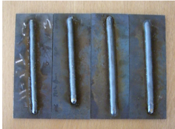
Şekil 4.1 Yeni nesil elektronik kaynak makinalarında karışım gaz ile farklı kaynak akımlarında elde edilmiş dikiş görüntüleri ( %82 Argon % 18 CO 2 ).
