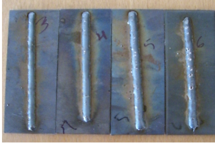
Şekil 4.2 Yeni nesil elektronik kaynak makinalarında CO 2 gaz ile farklı kaynak akımlarında elde edilmiş dikiş görüntüleri (%100 CO 2 ).
