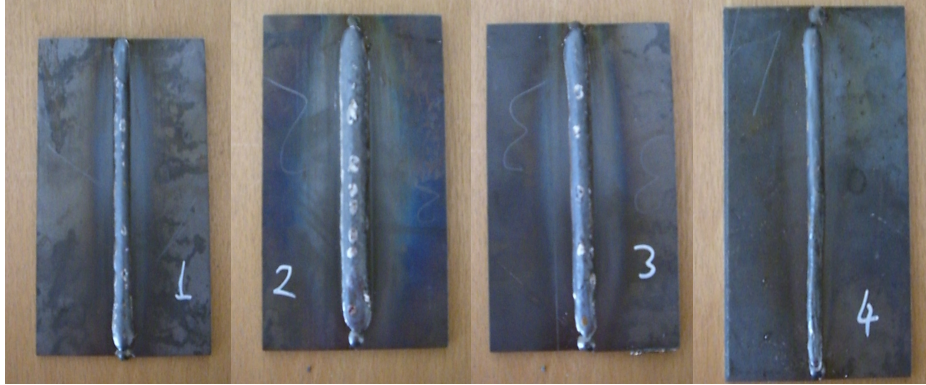
Şekil 4.9 Yeni nesil makinada darbeli kaynak yöntemiyle 170 amperde tüm kaynak parametreleri sabit, kaynak hızının değiştirilmesi sonucunda oluşan kaynak dikiş görüntüsü.
