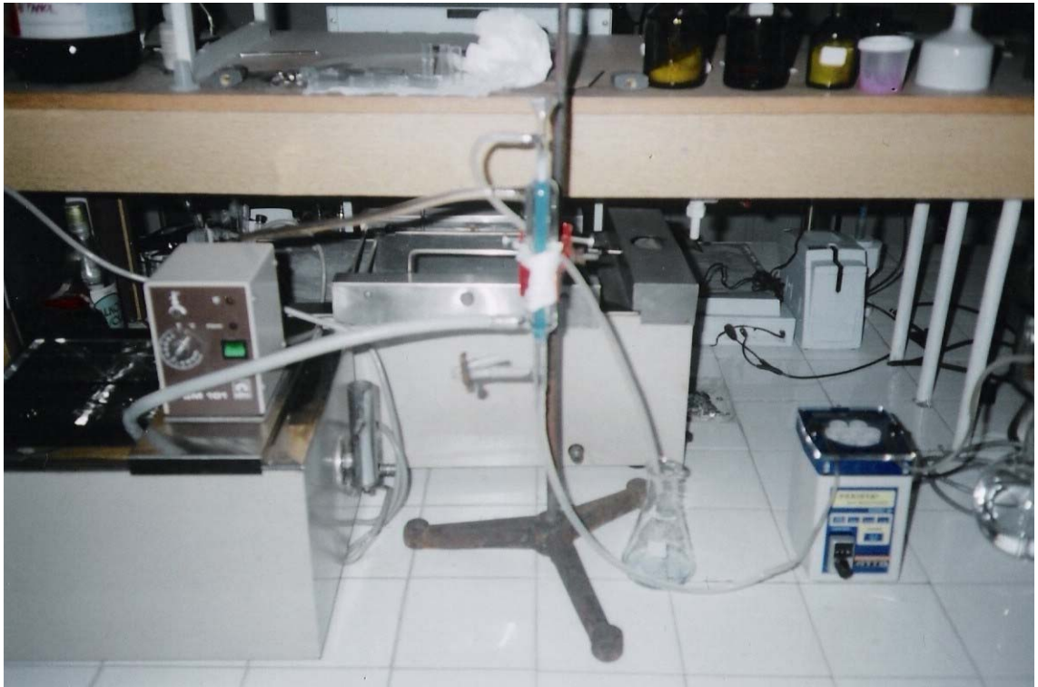
Resim 3.1. Sabit yataklı immobilize enzim reaktörü
