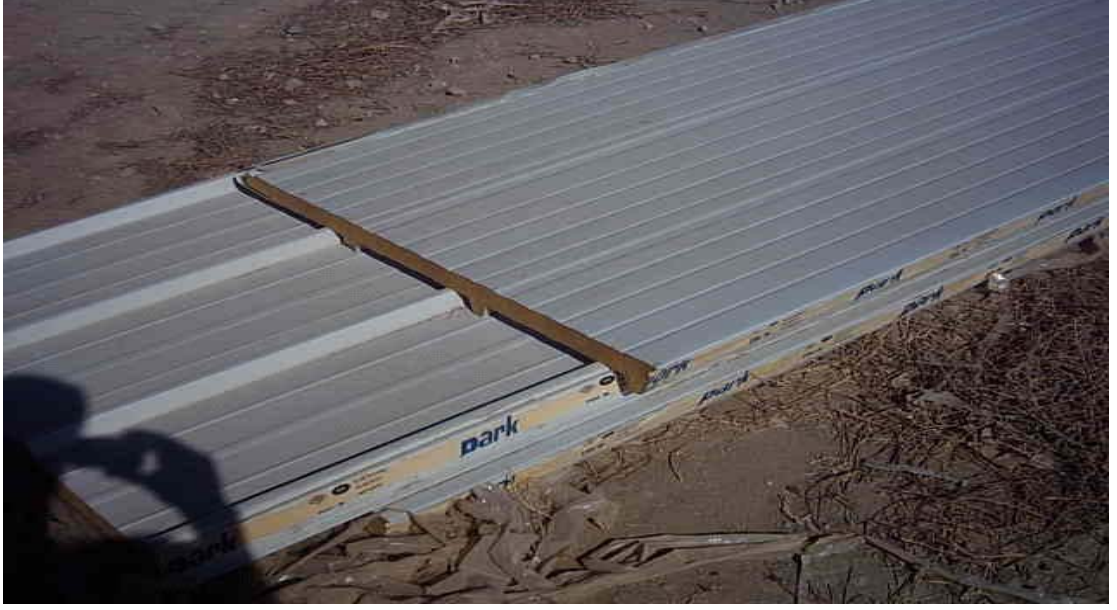
Şekil EK.20 Alüminyum sandviç panel çatı kaplaması malzemesi
