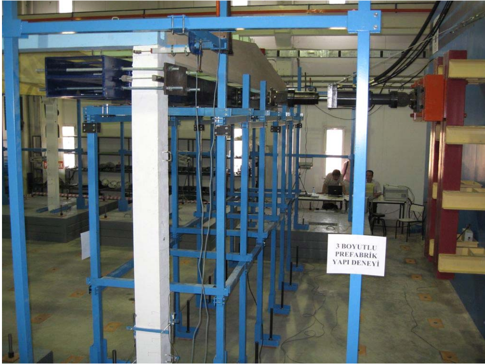
Şekil 4.52 3B Deney yapısı yükleme düzeneği
