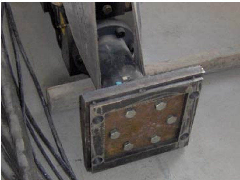
Şekil 3.25. Veren mesnet bağlantısı hazırlanması
