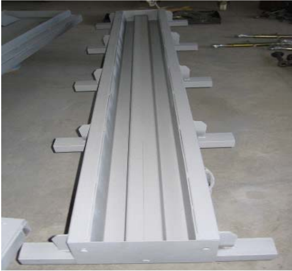
Őekil 4.7 PBA model oluk elik kalıbı
