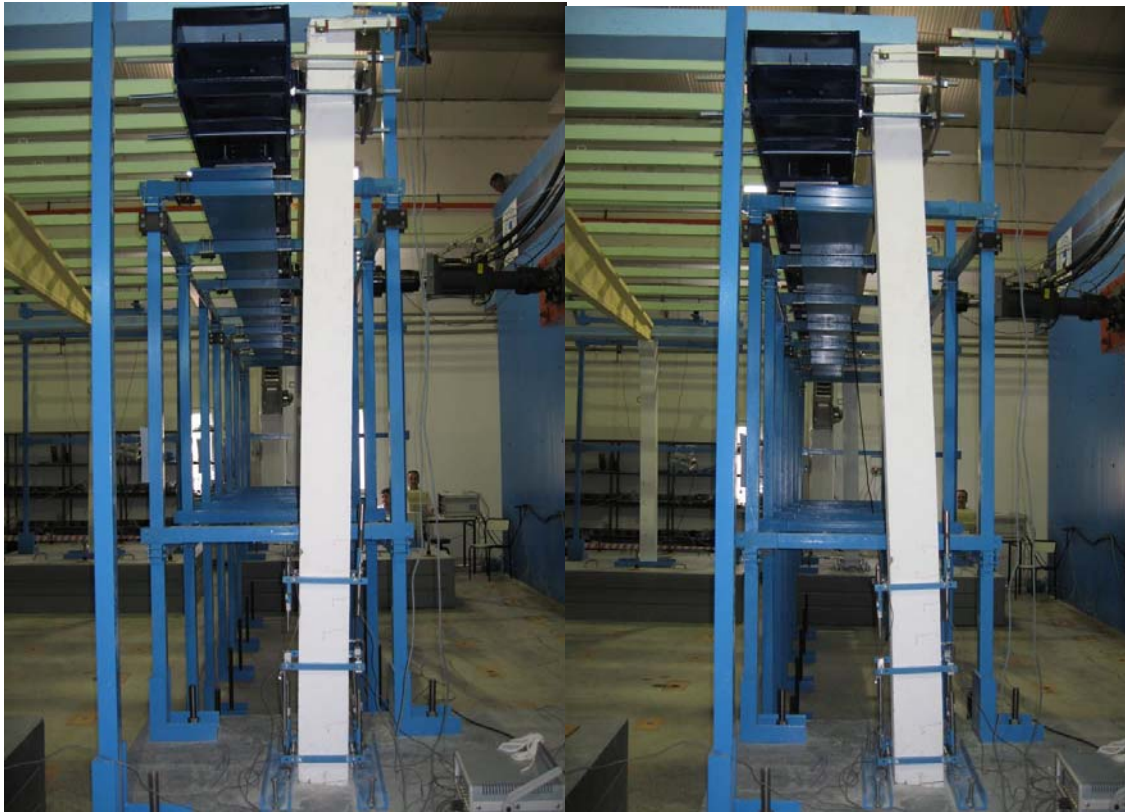
Şekil 4.57 Çekme ve itme anında 1 aksı kolon yerdeğiřtirmesi
