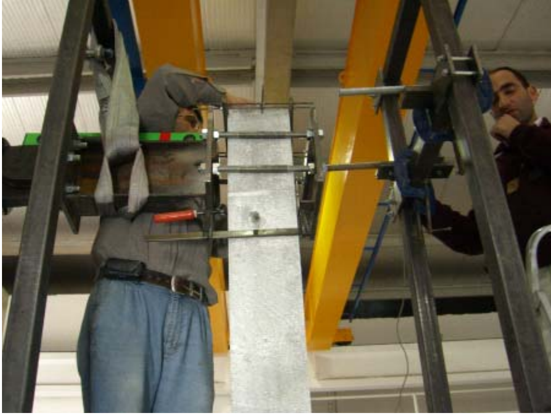
Şekil 4.37 Ölçüm düzeneği ve yerdeğiştirme ölçerlerin montajı
