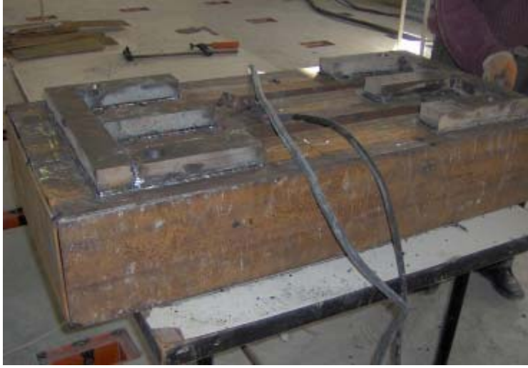
Şekil 3.22. Veren mesnedi yatay kızağının hazırlanması
