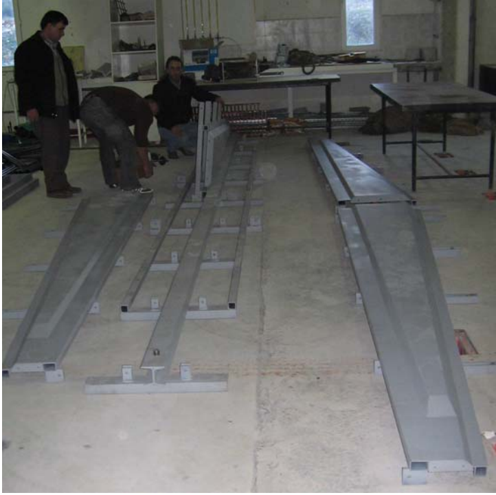
Şekil 4.8 PBA Model Makas çelik kalıbı montajı
