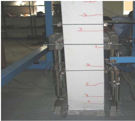
Şekil 2.10 Üçüncü adım sonunda kolondaki çatlaklar
