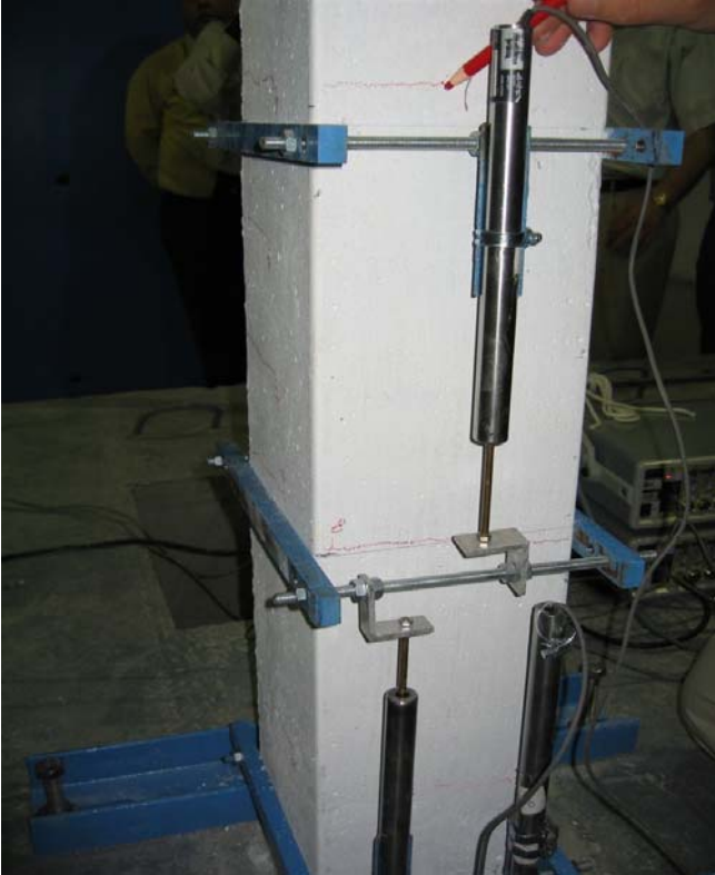
Şekil 4.76 Çatlak işaretlemelerinin yapılması
