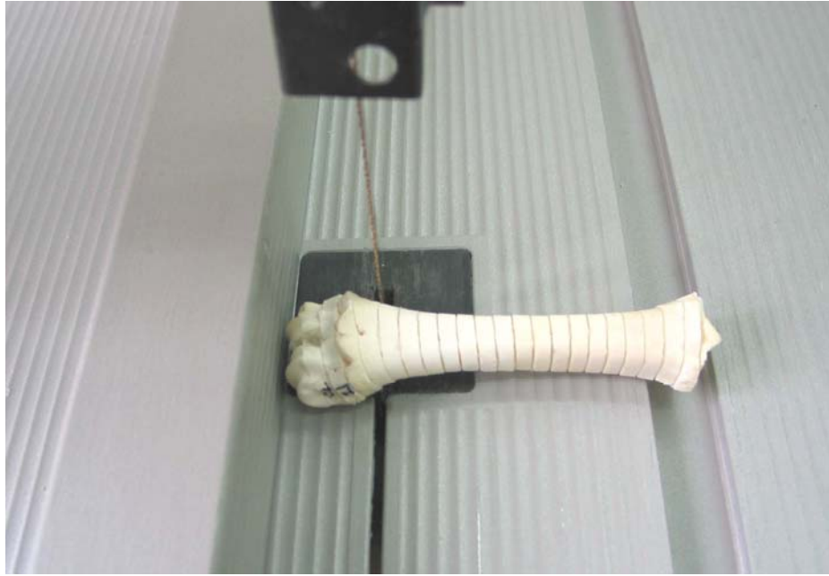
Sekil 3.8. Stereolojik kesitlerin alındığı testere makinesi
