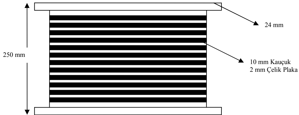
Şekil 6.6 İzolatör Katmanları
