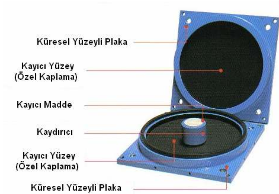
Şekil 5.5 Sürtünmeli Sarkaç Mesned (Oiles Corporation Tokyo/JAPAN)
