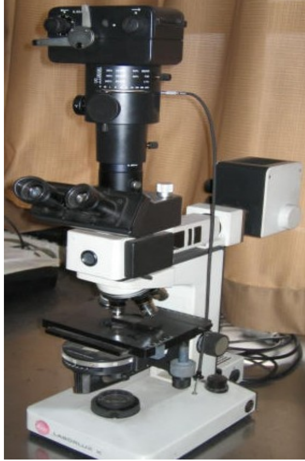
Şekil 7: Laborlux K (Leitz, Germany) fotoataşmanlı ışık mikroskobu
