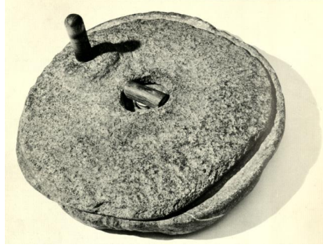
Şekil 3.4. Dönel taş sistemine sahip el değirmeni (Reynolds, 1970: 10)
