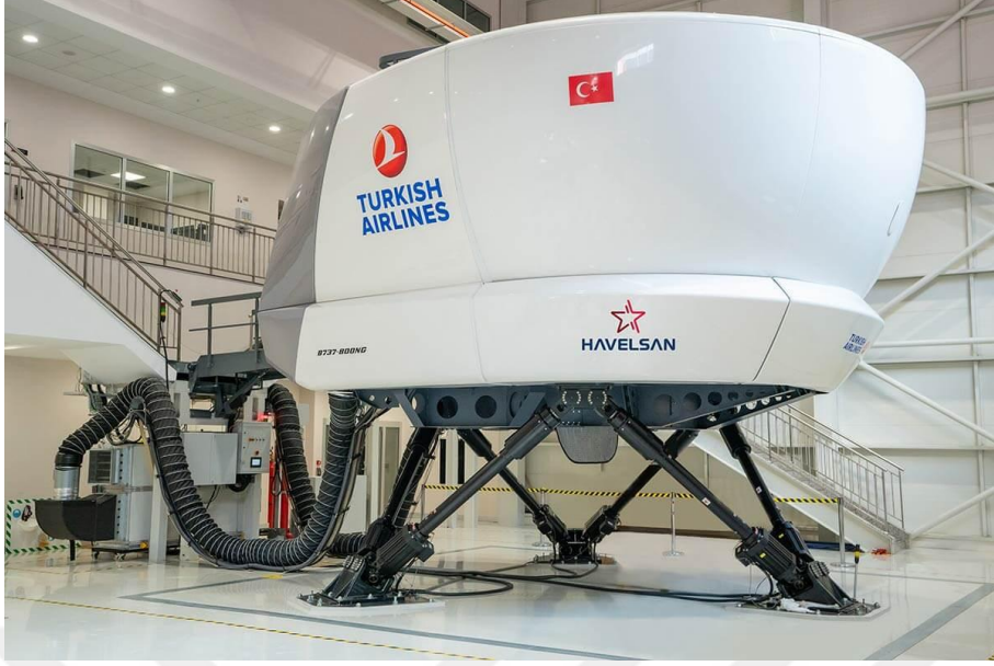
Şekil 5. HAVELSAN'ın geliştirdiği BOEING 737 NG Tam hareketli uçuş simülatörü
