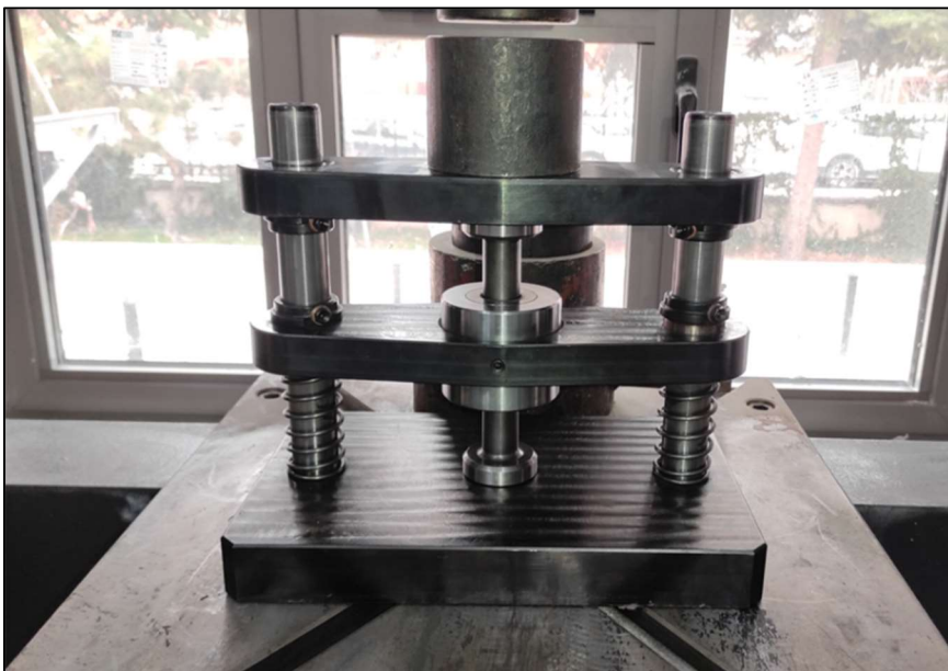
Resim 4.15. Tozların sıkıştırılmasında kullanılan kalıp
