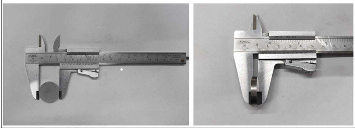
Resim 5.1. Distaloy AE %90, geri dönüşüm toz %10 karışımından oluşan parçanın sinterleme sonrası görüntüsü (D=25,4 mm, t=4,1 mm)
