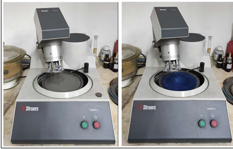
Resim 4.19. Struers zımparalama ve parlatma makinesi; zımpara işlemi (soldaki), parlatma işlemi (sağdaki)
