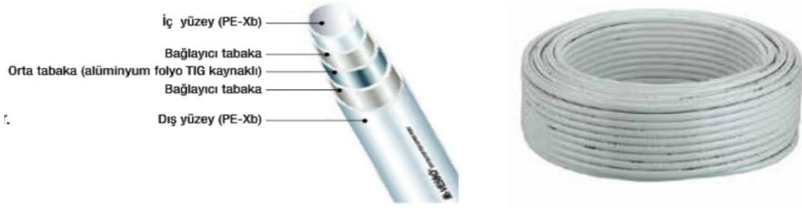
Şekil 3.12. ALPEX Boru Katman Dağılımı
