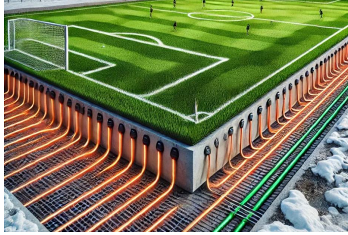
Şekil 3.5. Çim Sahalarda Yerden Isıtma Sistemi
