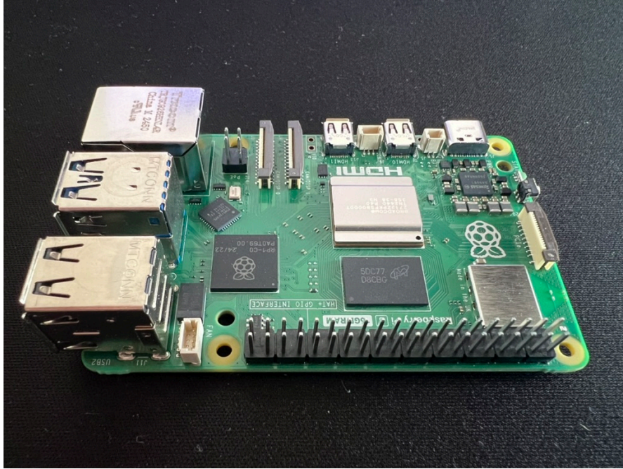
Şekil 10.1: Raspberry 5 gömülü sistem modülü.
