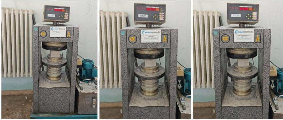
Şekil 6.10. Harç numunelerinin basınç dayanımı testi
