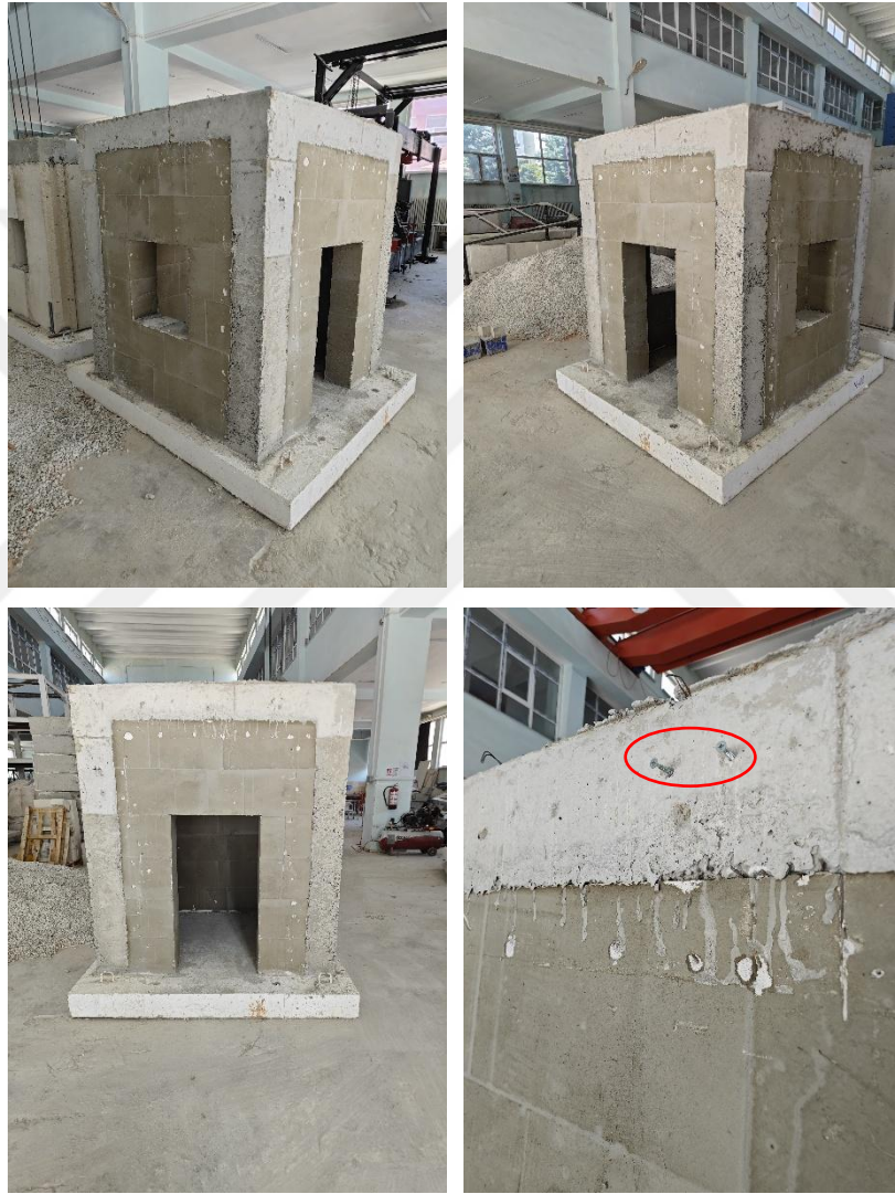
Şekil 6.18. Kuşatılmış yığma yapı numunesinin kalıp sökümü ve sensör için yer ayarlanması
