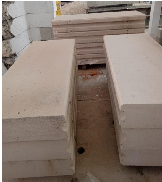
Şekil 6.9. Donatılı panel sistemli yığma yapı numunesinde kullanılan duvar paneli
