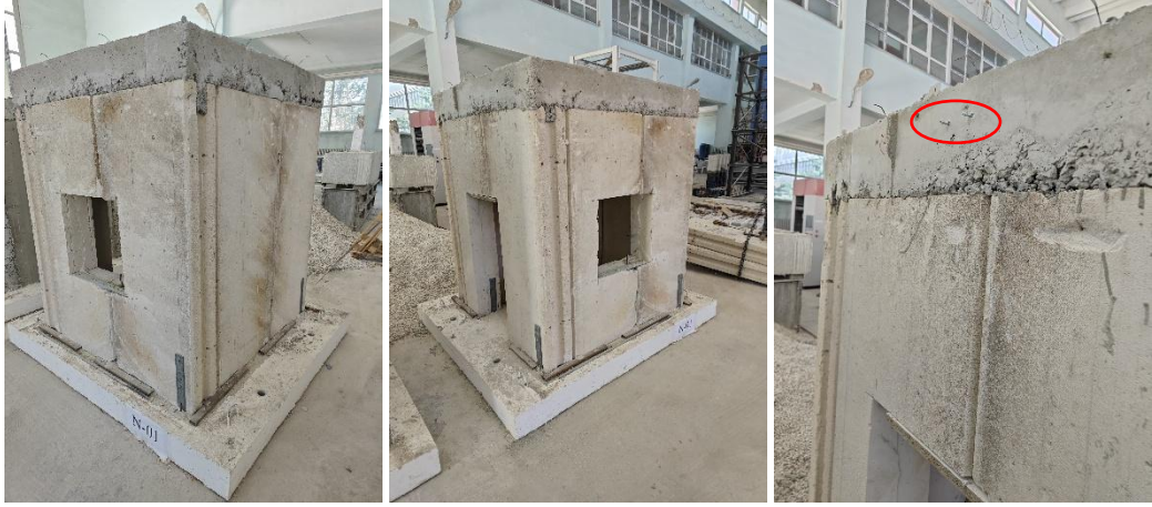
Şekil 6.22. Donatılı panel sistemli yığma yapı kalıp sökümü ve sensör yerinin ayarlanması
