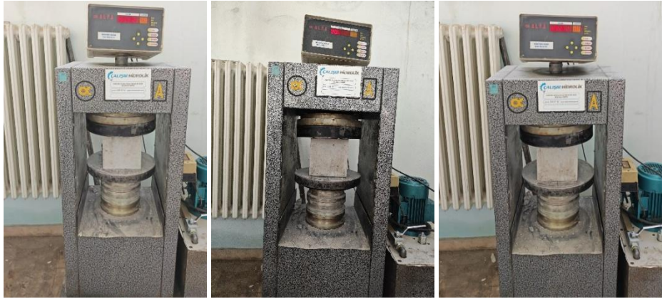
Şekil 6.11. Beton numunelerin basınç dayanımı testleri
