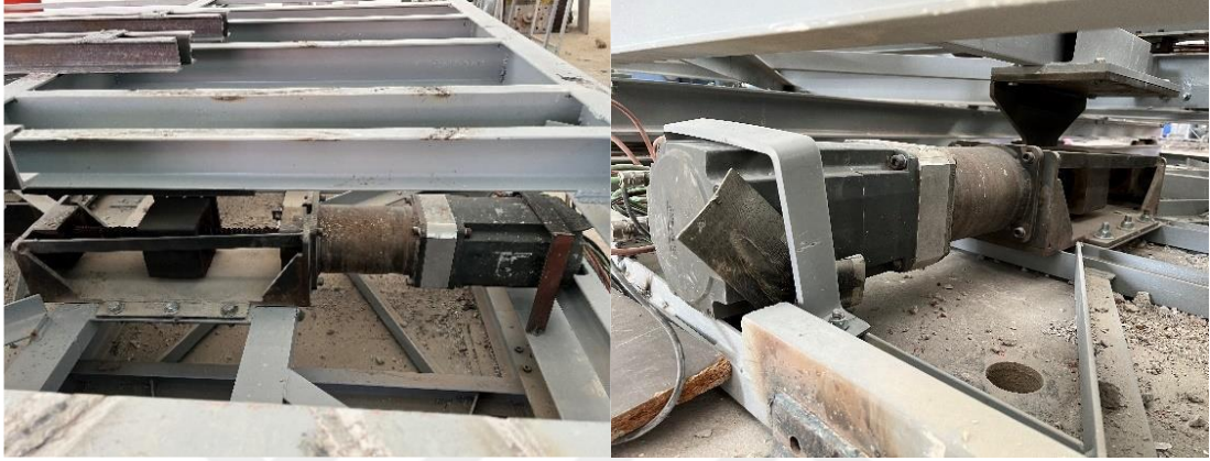
Şekil 6.24. X ve Y yönünde bulunan Servo Motorlar
