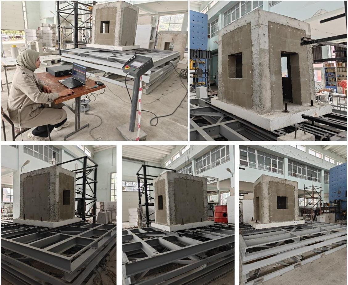
Şekil 7.3. N-02 Kuşatılmış yığma yapı numunesinin deney öncesindeki görünümü
