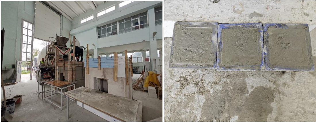
Şekil 6.21. Donatılı panel sistemli yığma yapı numunesine beton dökümü ve numune alınması
