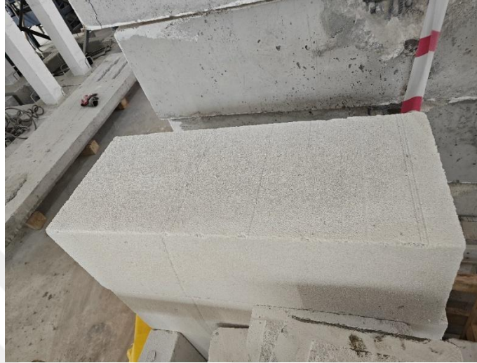
Şekil 6.8. Kuşatılmış yığma yapı numunesinde kullanılan G4 gazbeton
