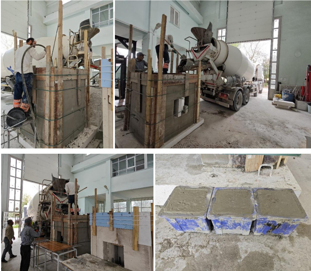
Şekil 6.17. Kuşatılmış yığma yapı numunesine beton dökümü ve vibratör tutulması
