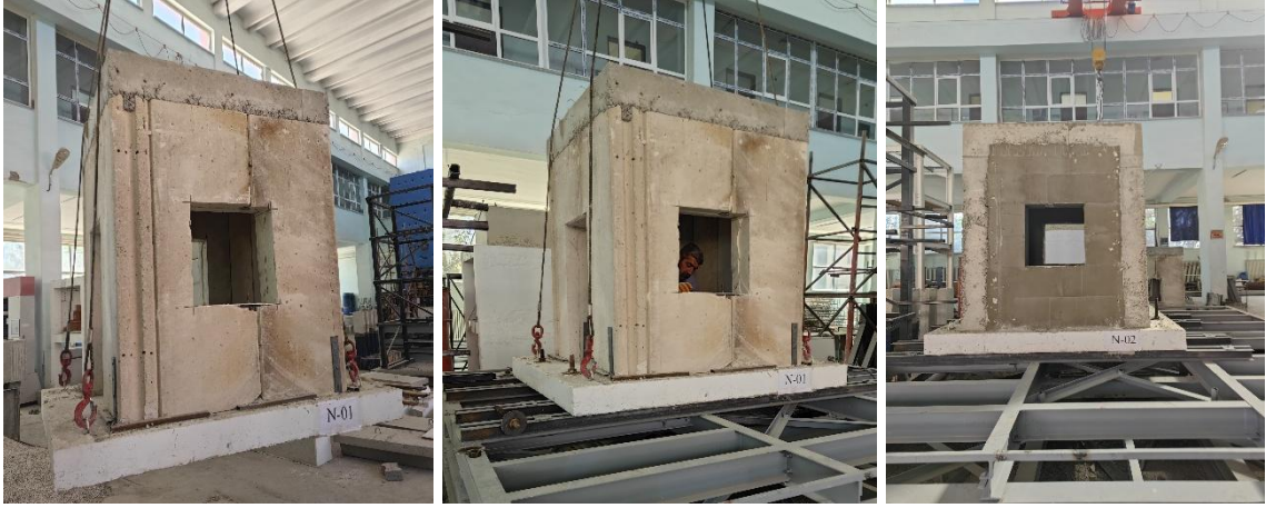
Şekil 6.27. Numunelerin vinç ile taşınması ve sarsma masasına bağlanması
