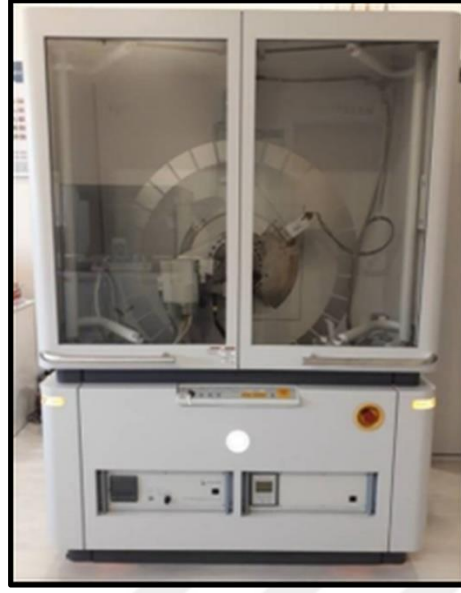
Şekil 3.4. Panalytical EMPYREAN marka XRD cihazı.
