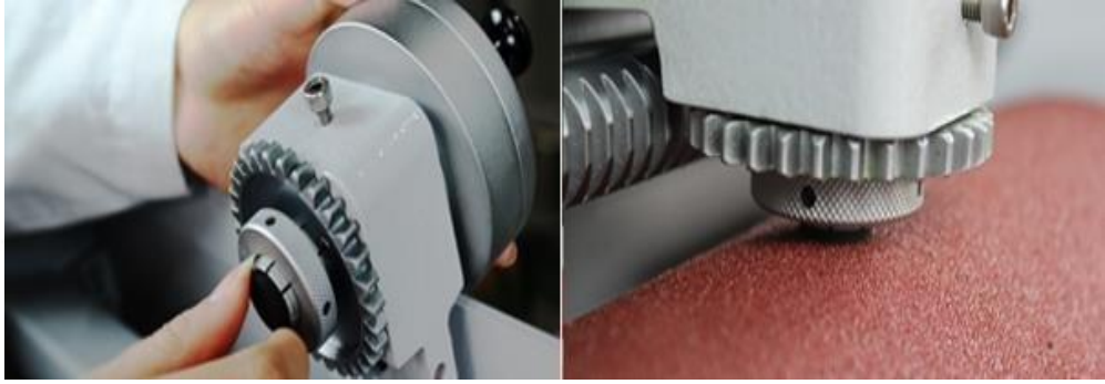
Şekil 6.11. Aşınma analizi yapılan numunelerin test esnasındaki görüntüsü
