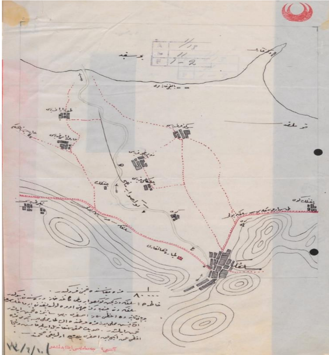
Şekil 30. 1/80000 ölçeğinde krokidir. Hatıra: Silifke'den geçen Göksu Irmağı, Kâğıthane Deresi'nden büyüktür. Silifke'den güney deniz tarafı ova olduğundan ırmakın akış sürati saniyede azami 0.50 asgari 0.30 santimetre tahmin edilmiştir. En geniş yeri 100 metre, en dar yeri ise 20 metre tahmin edilmiştir. Suyun derinliği tahminen azami 2.5, asgari 1 metredir. 1990
