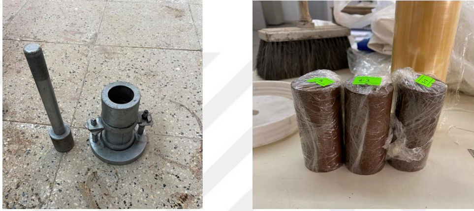
Şekil 5.17. UCS deneyi için zemin numunelerinin hazırlanışı
