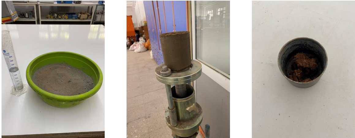
Şekil 5.18. Proktor deneyi için zemin örneklerinin hazırlanışı
