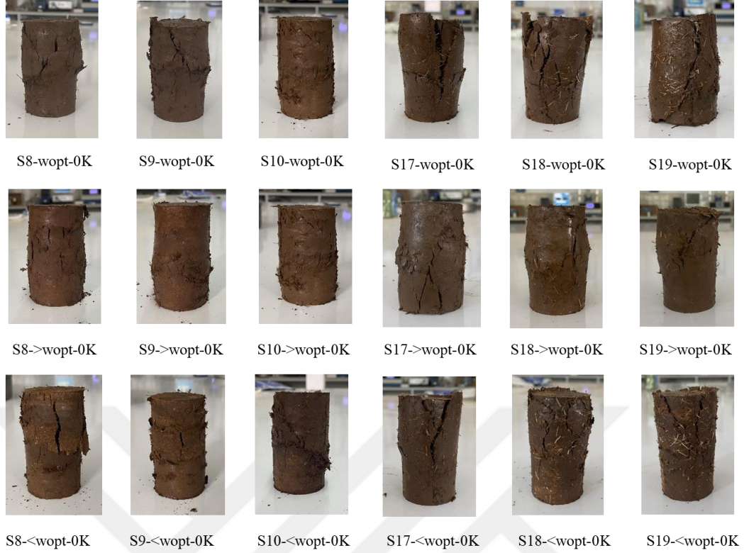
Şekil 6.19. Farklı su içeriklerinde farklı oranlarda hazırlanan lif katkılı numunelerinin (S8, S9, S10, S17, S18, S19) kırılma modları
