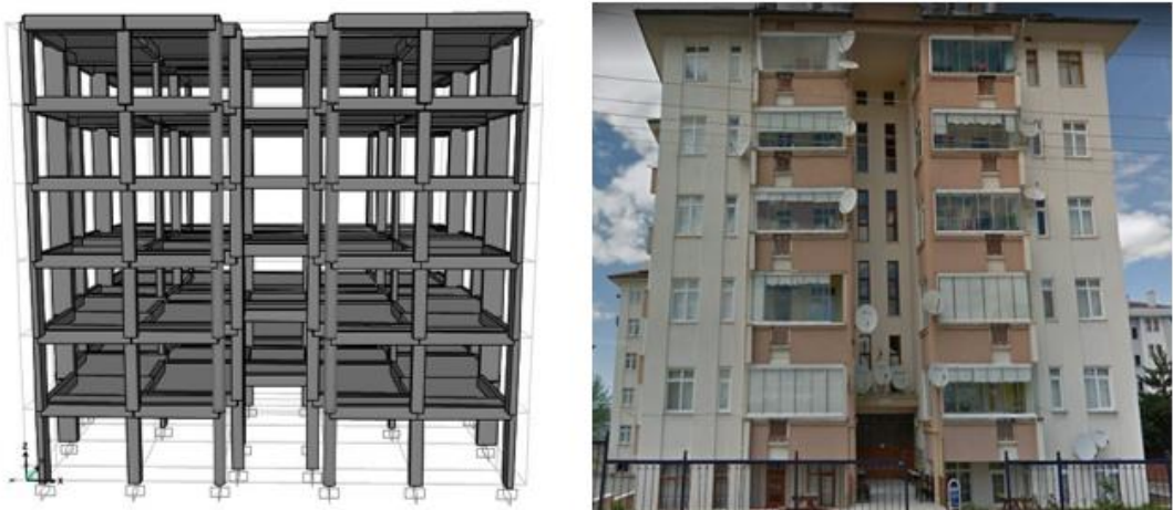
Şekil 6.4 : Cebrail Tip-1 SAP2000 modeli ve bina görüntüsü.
