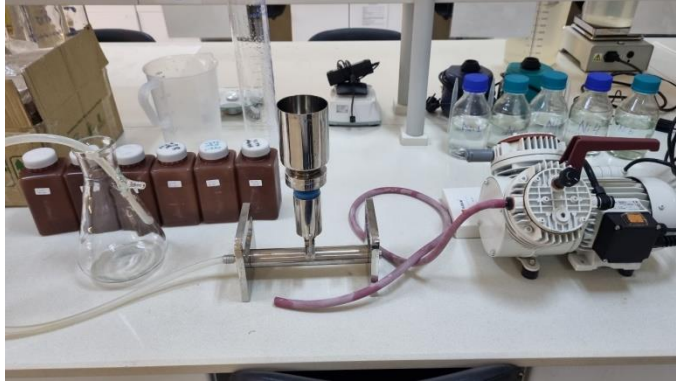
Şekil 3.2. Atıksu filtrasyonunda kullanılan sistem.
